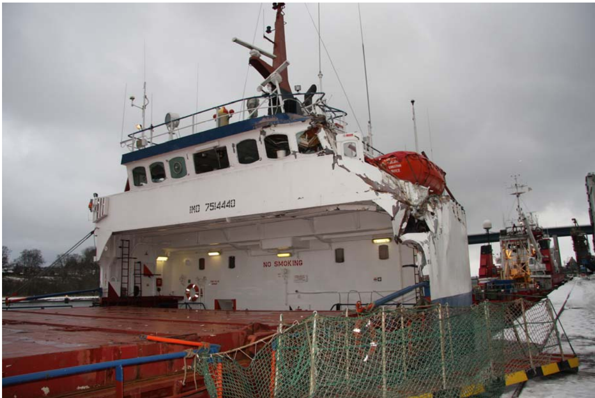
Zerstörte Brücke des Stückgutschiffs MALAGA nach Kollision mit dem Containerschiff NATIONAL GLORY, BSU Untersuchungsbericht Az.523/10, veröffentlicht am 12.12.2011 Quelle: BSU
