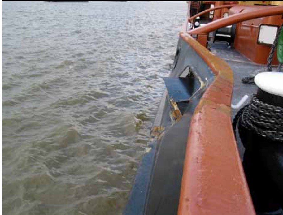
Abbildung 9: Schaden an Oberdeck auf der Backbordseite der OCEANIC
