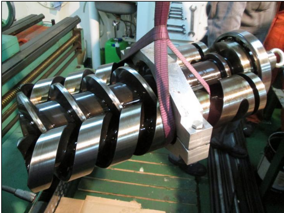
Abbildung 33: Pumpenspindeln nach Demontage
