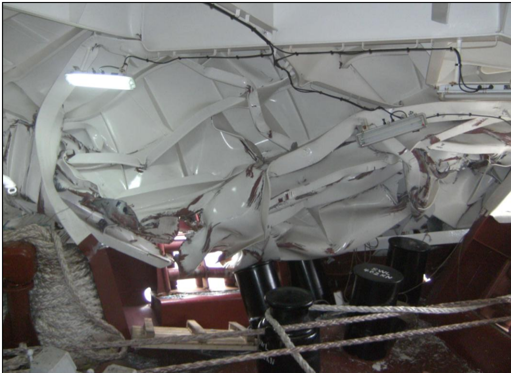
Abbildung 14: Beschädigungen vordere Manöverstation CMS CONMAR AVENUE
