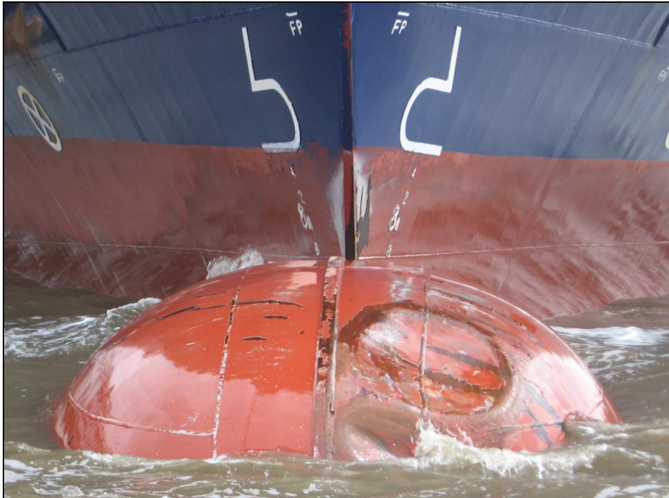
Abbildung 13: Deformierungen Bugwulst CMS CONMAR AVENUE
