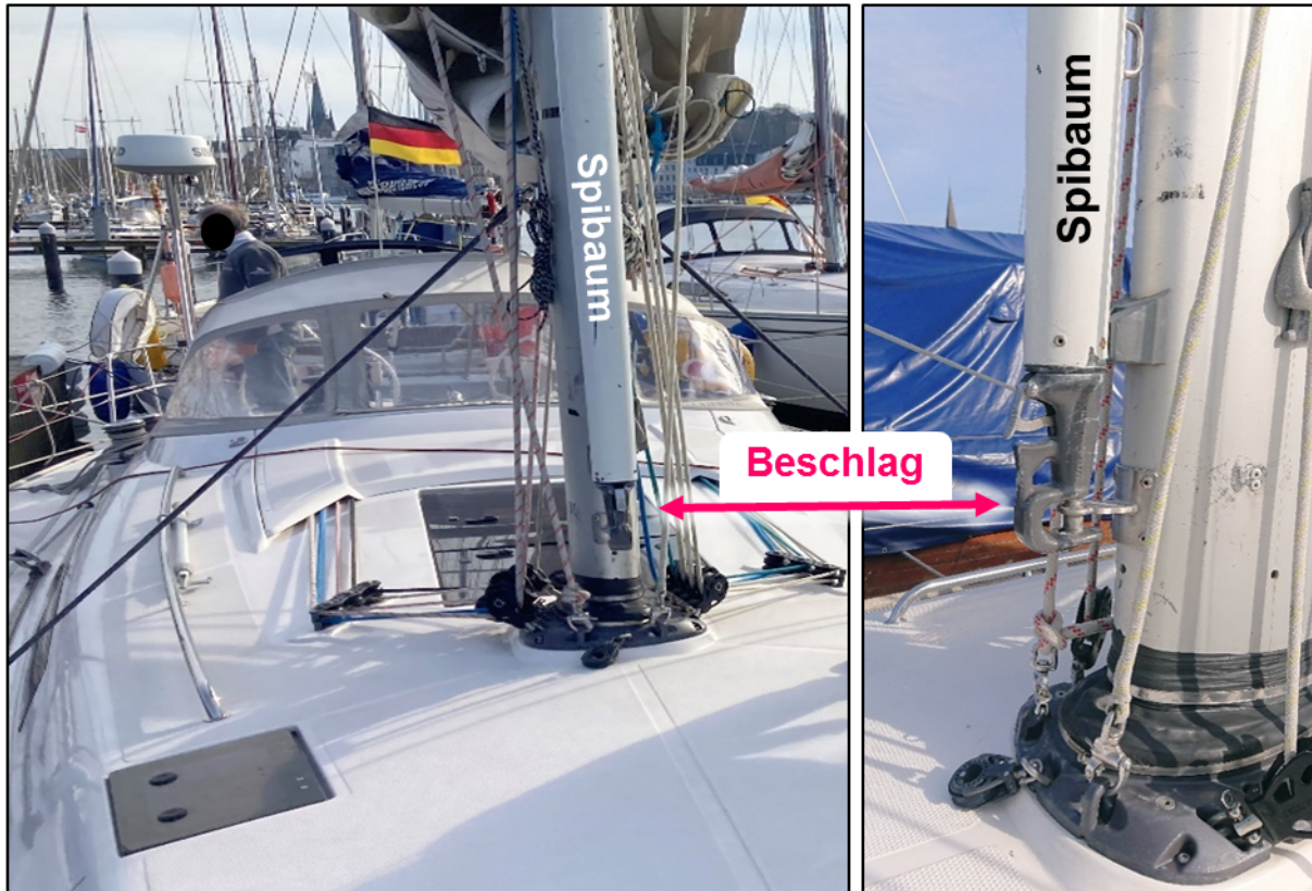
Abbildung 5: Am Mast befestigter Spinnakerbaum, wo sich die Schot verhakte 17
