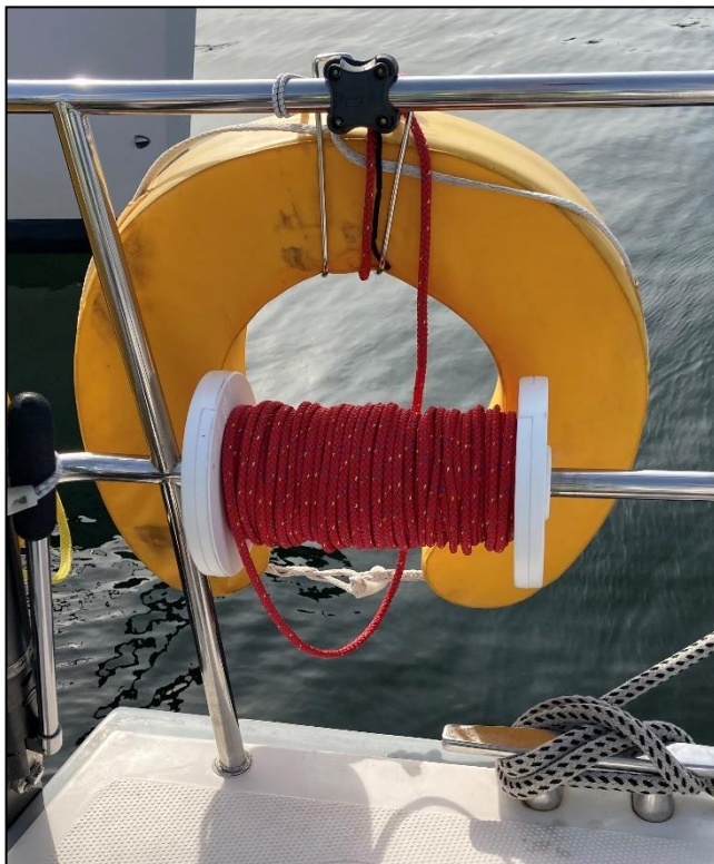
Abbildung 8: Backbordseitiger Hufeisen-Rettungsring mit Leine 20
