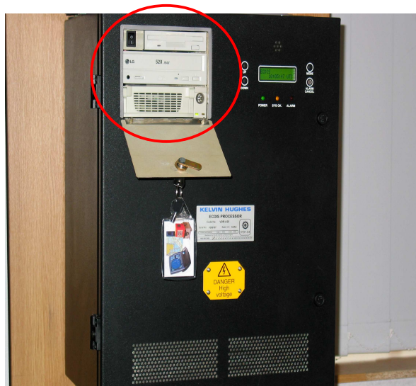
Foto BSU Main Unit eines Kelvin Hughes VDR mit Wechselfestplatte, DVD-Laufwerk und Diskettenlaufwerk
