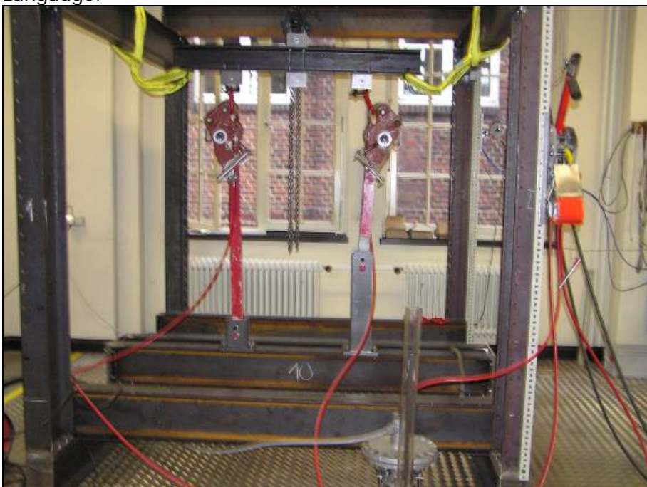
Abb. 9: Versuchsaufbau: Fundamentrahmen mit Heißhaken, Bedienkabel, Wasserdruckdose und Bedieneinheit. Bedienkabel sind mit großen Radien auf dem Fundamentrahmen zwischen den einzelnen Elementen verlegt.
