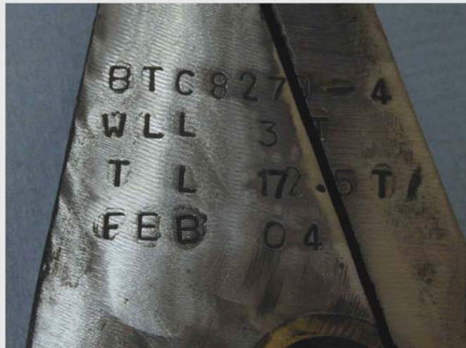
Abb. 3: Stempelung an Haken „Vorn“
