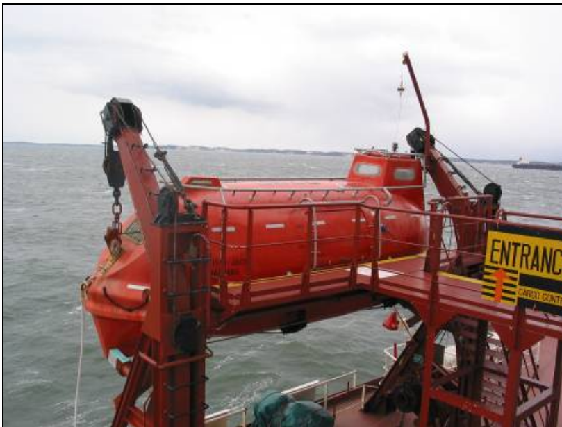
Abb. 1: St.Bd.-Rettungsboot Typ HDL 71 CF auf dem MT „OLIVER JACOB“
