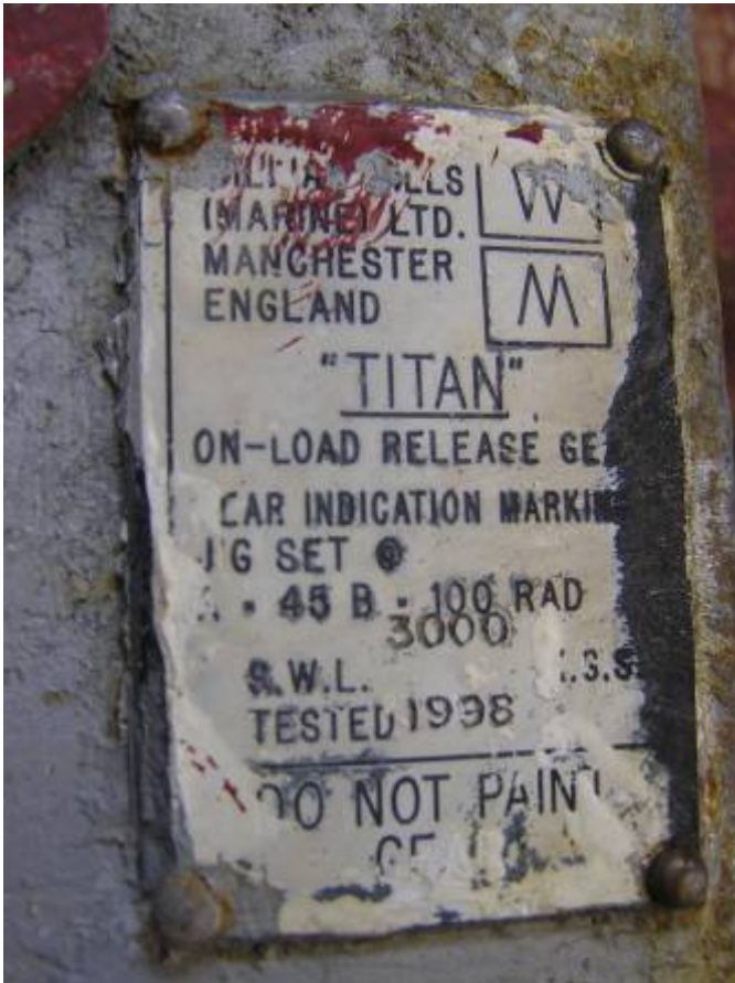
Abb. 2: Hersteller-Typenschild des hinteren Heißhakens
