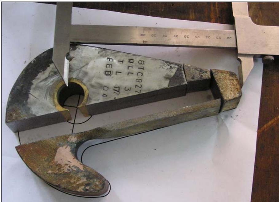
Abb. 21: Vorderer Haken: Messung der Abmessungen nach der Probenentnahme
