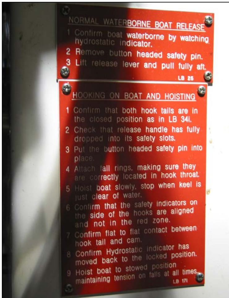
Abb. 29: Bedienschild LB 25 und Bedienschild LB 171.
