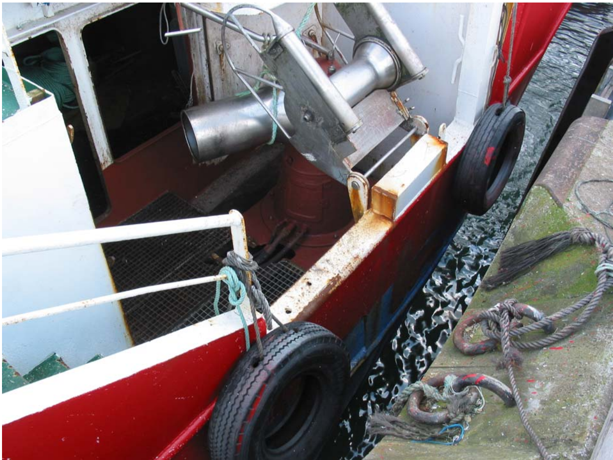
Abbildung 19: Zugang zum oberen Fischverarbeitungsraum auf Steuerbord-Seite. Die Öffnung liegt hinter dem Schanzkleid. Durch die vordere Öffnung wird das Netz ausgebracht, durch die hintere betritt man den Fischraum. Quelle: BSU
