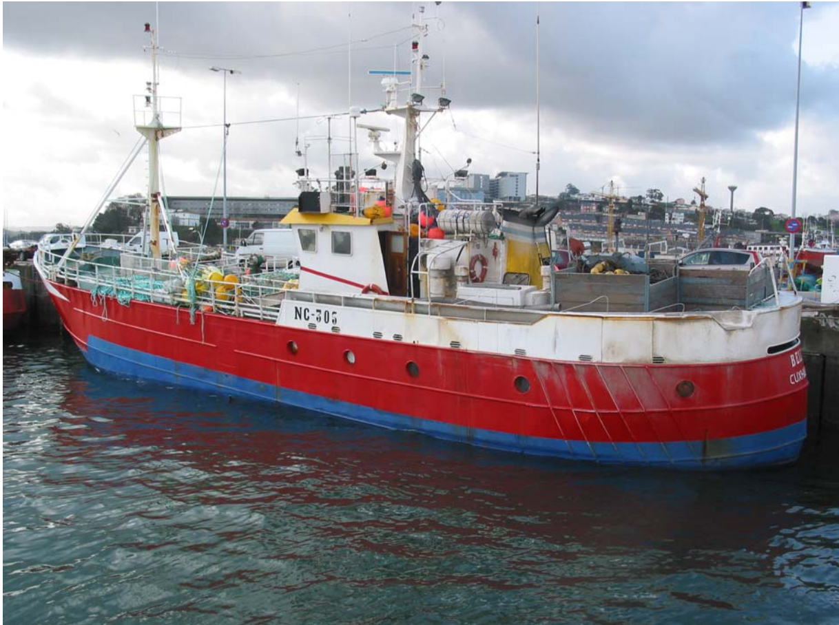
Abbildung 20: Blick auf die BB- Seite der Ortegale UNO. Es ist keine Wasserablaufpforte zu erkennen, d. h. der obere Fischverarbeitungsraum kann nicht nach außen gelenzt werden.
