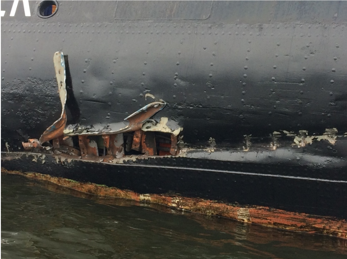
Aufgerissene Außenhaut der STETTIN, Quelle WSP
