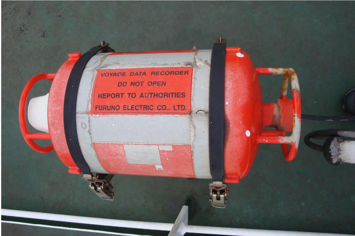
Speicher kapsel eines VDR, Quelle BSU
