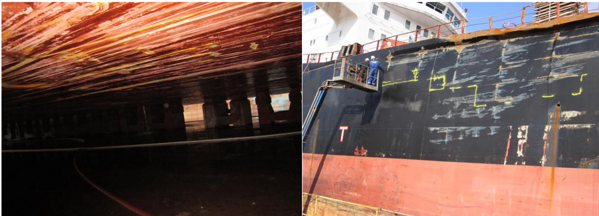
Schäden an der SEATROUT, linke Seite: tiefe Kratzspuren am Unterwasserschiff; rechte Seite: Dellen und Abriebspuren an der Steuerbordseite; Quelle BSU
