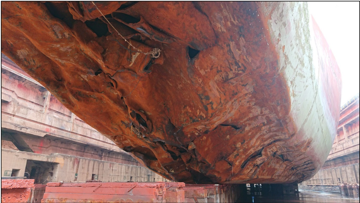
In der Werft werden schwere Schäden am Unterwasserschiff festgestellt, Quelle Reederei
