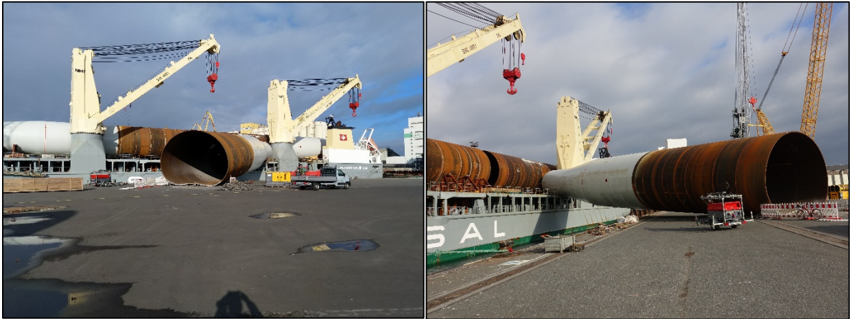
Der auf die Pier gerutschte Pfahl beschädigt Schiff und Kaianlage, Quelle BSU
