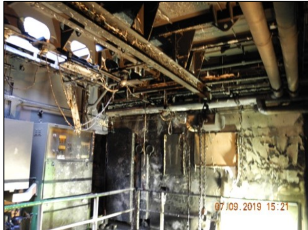
Abb. links und oben: Folgen des Feuers im Maschinenraum und sich anschließenden Bereichen – die schweren Zerstörungen sind offensichtlich. (Quelle: BSU)
