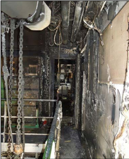
Abb. links und oben: Folgen des Feuers im Maschinenraum und sich anschließenden Bereichen – die schweren Zerstörungen sind offensichtlich. (Quelle: BSU)
