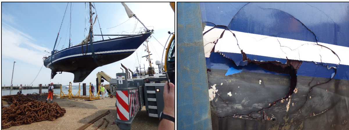
Abbildungen 14 und 15: Bergung der SHARKY und das Loch im Rumpf 16
