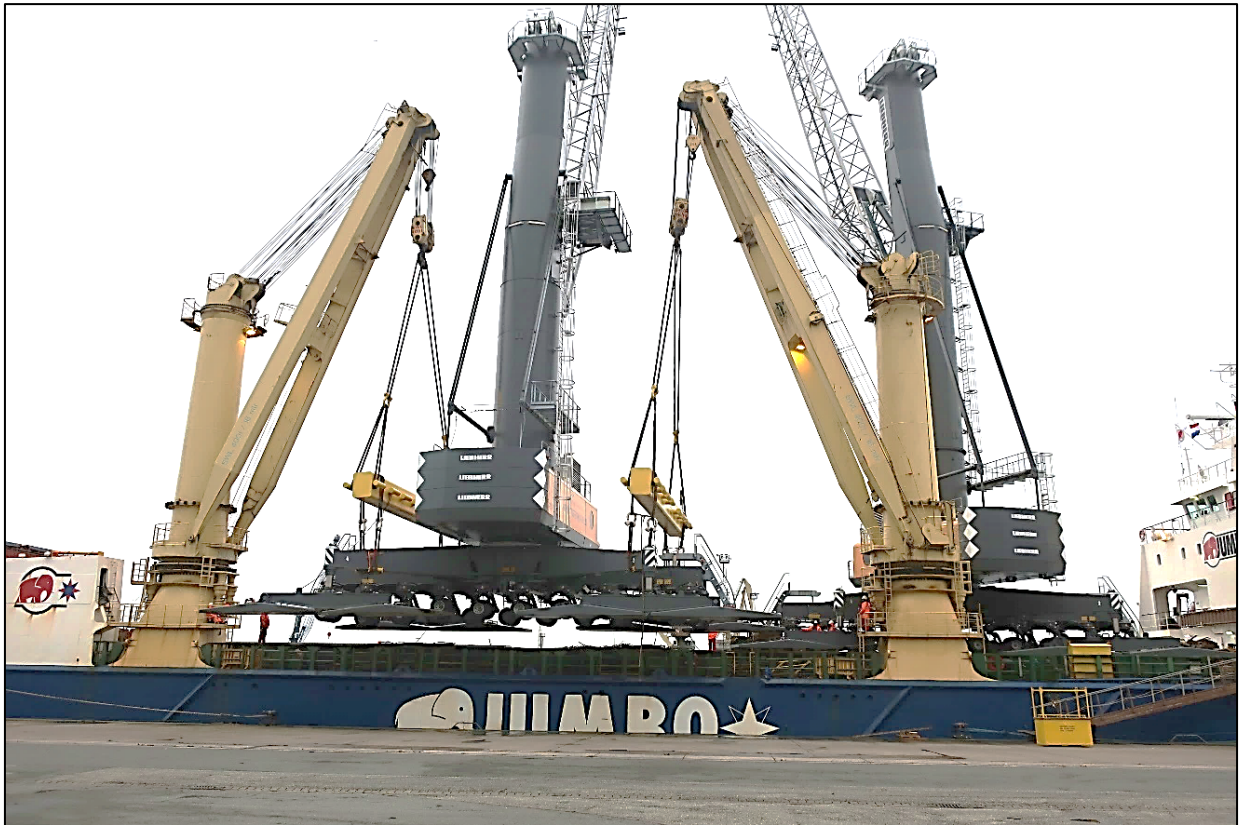
Abbildung 9: „Tandem Lift“ von Kran 211
