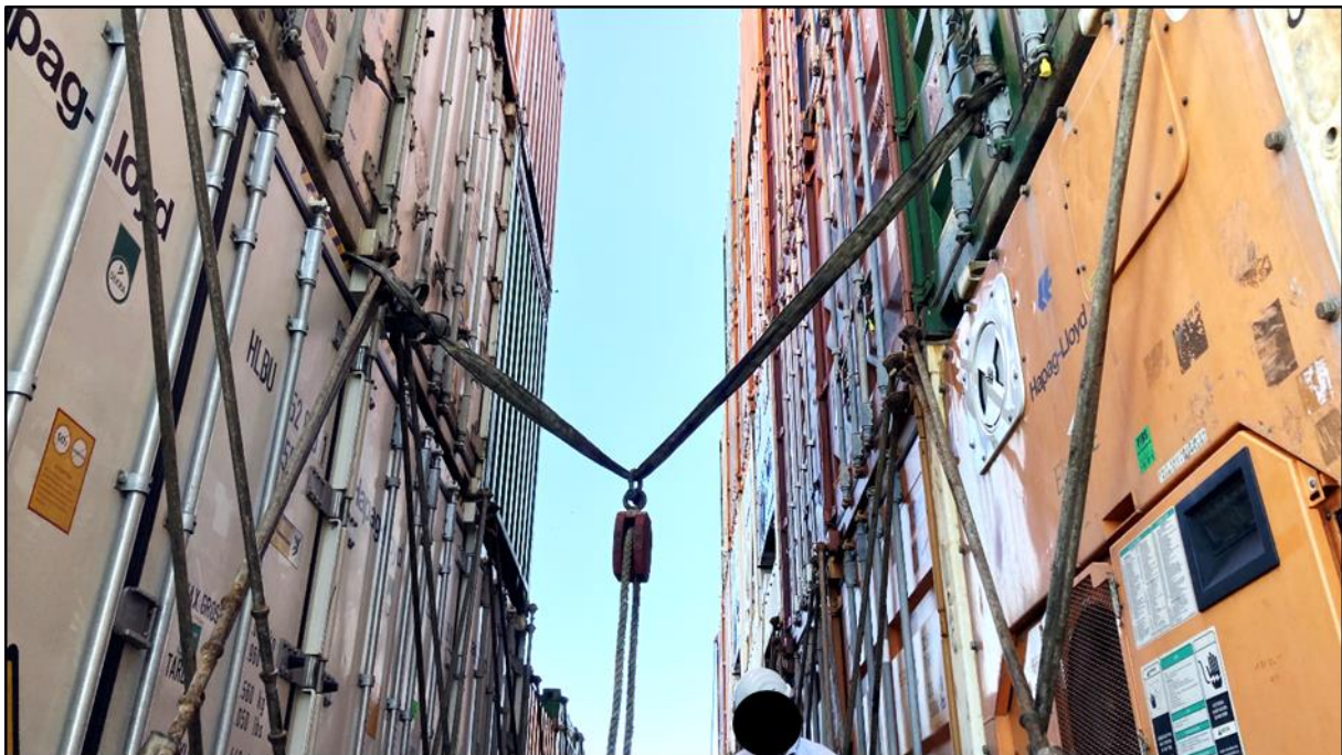
Abbildung 5: Seilkonstruktion zur Evakuierung über der Einstiegs Luke (nachgestellt) 10
