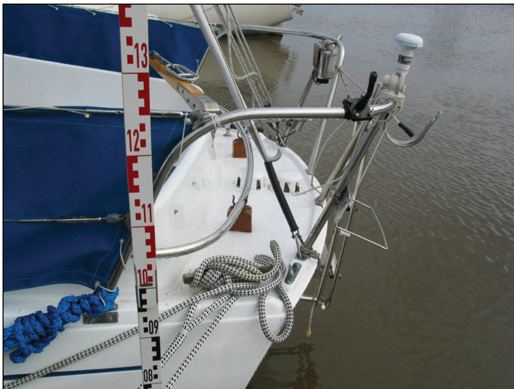
Abbildung 1: Bestimmung von Freibord und Relingshöhe bei einem Sportboot
