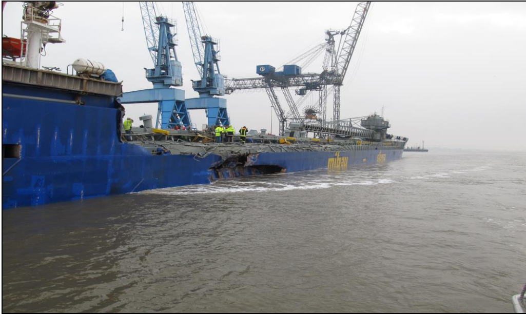
Wassereintritt an der Steuerbordseite des Schüttgutfrachters SPLITTNES; BSU Untersuchung Az. 507/11, laufende Untersuchung am 31.12.2012
