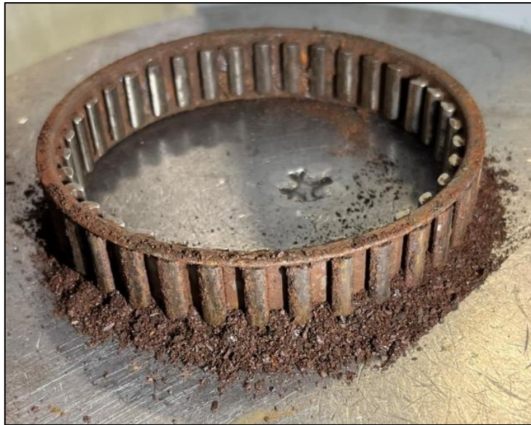
Abbildung 5: Freilauf nach Demontage; Spuren massiver Korrosion der Klemmkörper und des Klemmkörperkäfigs
