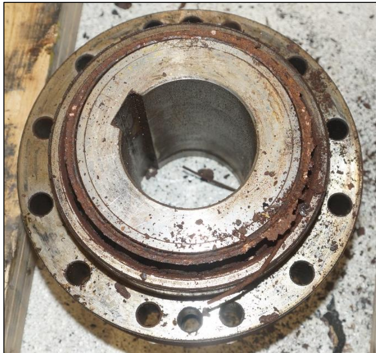
Abbildung 4: durch Witterungseinflüsse verschlissene Abdichtung des Freilaufmoduls
