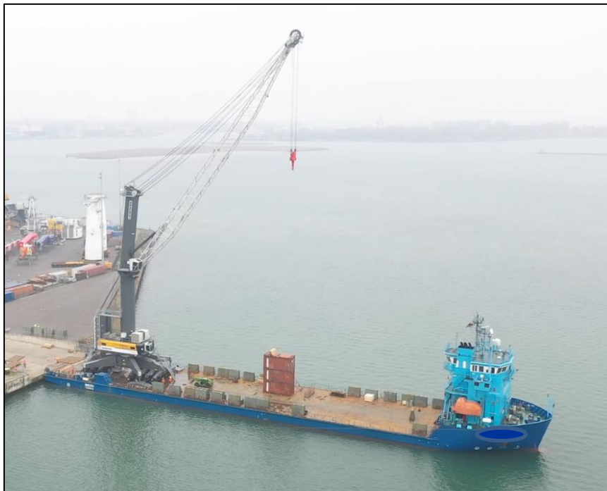
Verladung eines Hafemobilkrans 1
