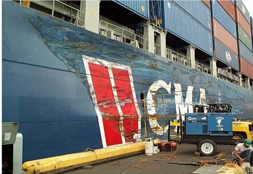
Abbildung 3, Notreparatur an der Pier in Honolulu des CMS „VILLE D`ORION“
