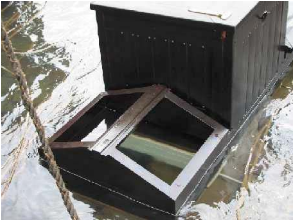
Abbildung 18, Skylight AK Schonermast ohne Deckel
