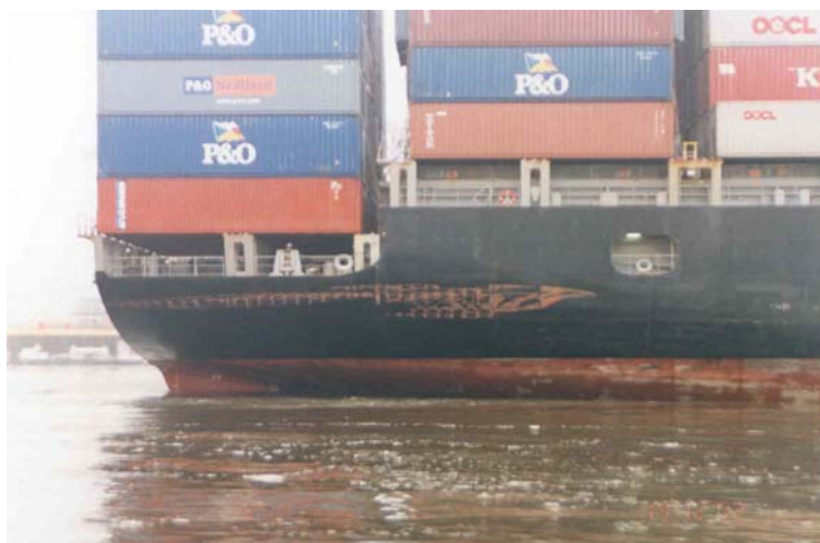
Abbildung 5: Schaden CMS P&O NEDLLOYD GENOA, Stb.-Seite Achterschiff 1
