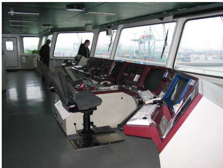
Abbildung 2: Brückenfahrstandkonsole von Steuerbord
