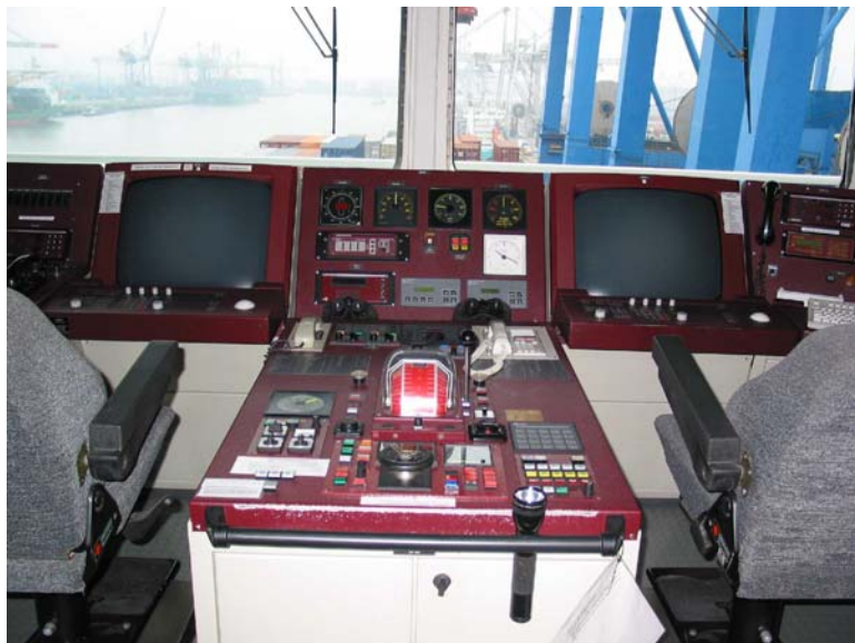
Abbildung 4: Fahrstandkonsole mit Blick auf die Radaranlagen
