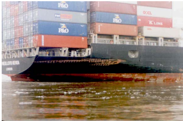
Abbildung 6: Schaden CMS P&amp;O NEDLLOYD GENOA, Stb.-Seite Achterschiff 2
