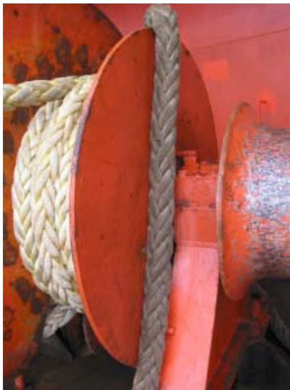
Abbildung 12: Rekonstruktion des Leinenklemmers nach Aussage des Bootsmannes am 5. Februar 2004
