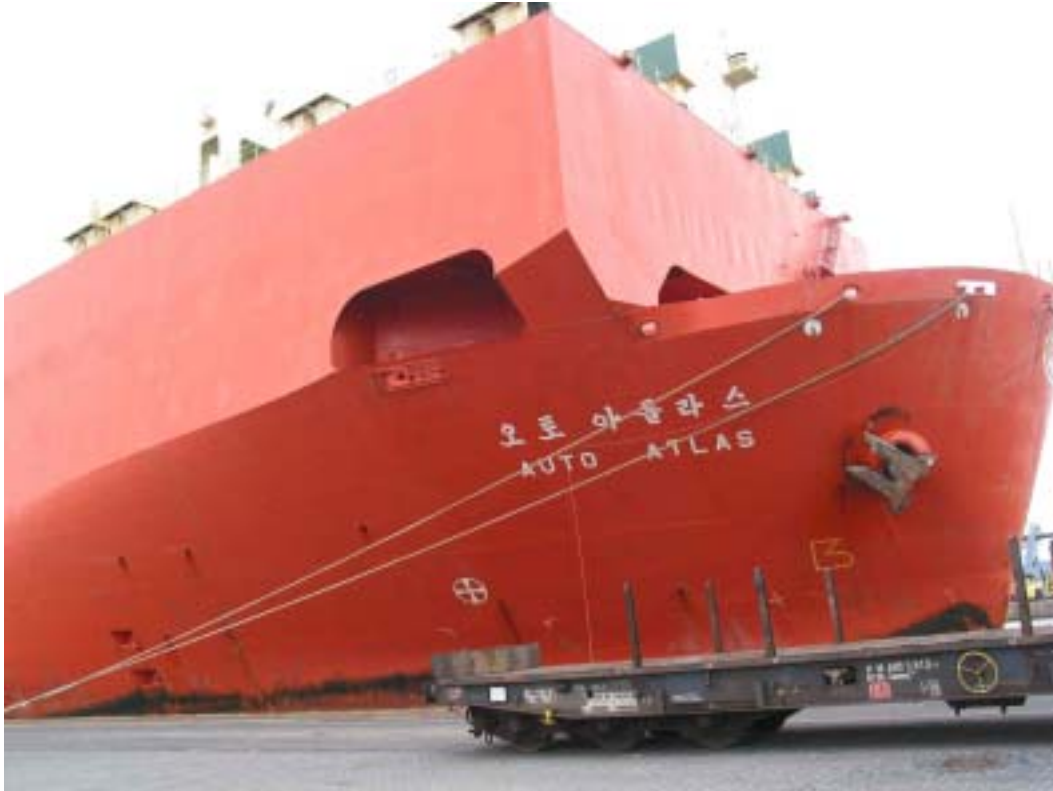
Abbildung 19: Vorspring unterhalb des Vorschiffüberbaus
