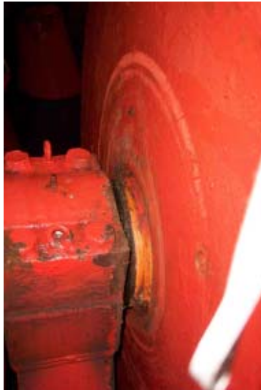
Abbildung 4: Schleifspuren am Seitenblech (Foto Kriminalpolizei Bremerhaven)
