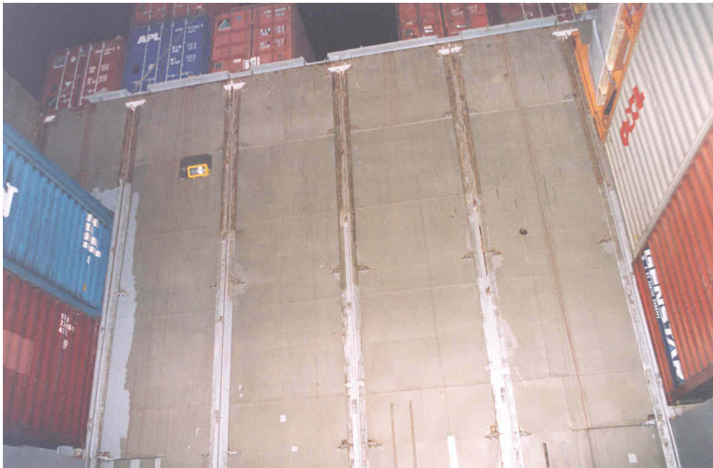
Abbildung 5, Beladung und Laschung der Container auf Luke 1
