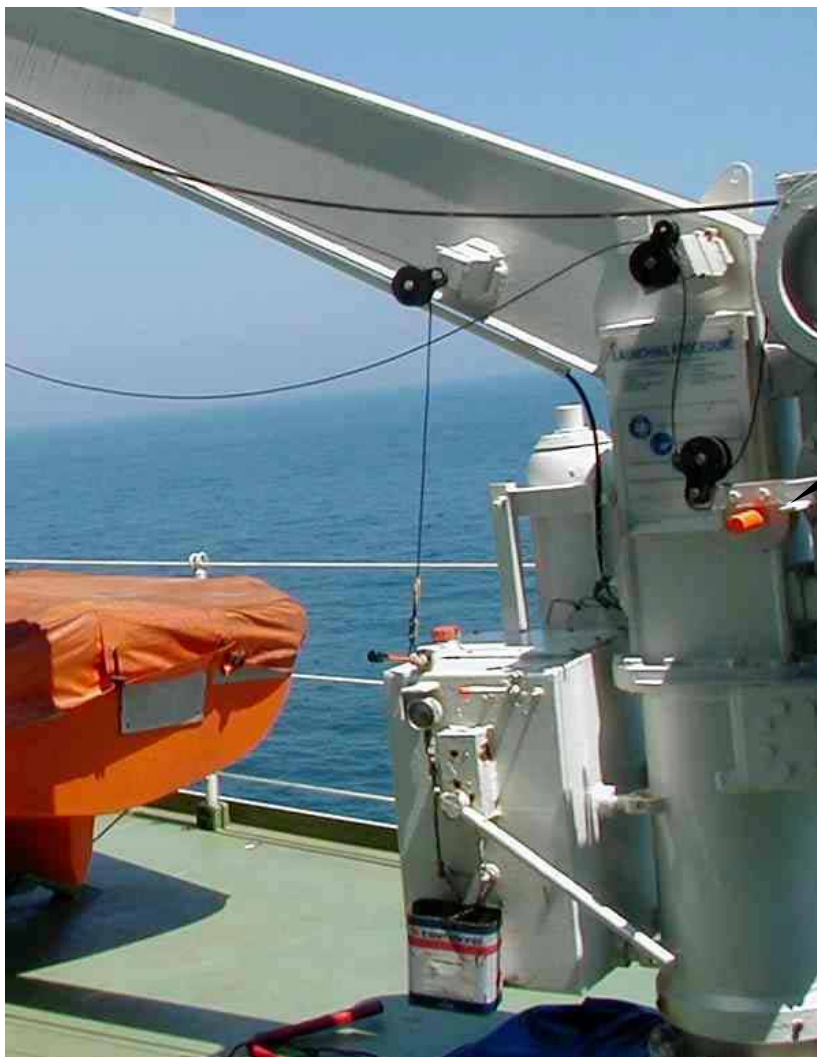
Abbildung 21: Montierter Sicherheitsriegel kurz nach dem Unfall
