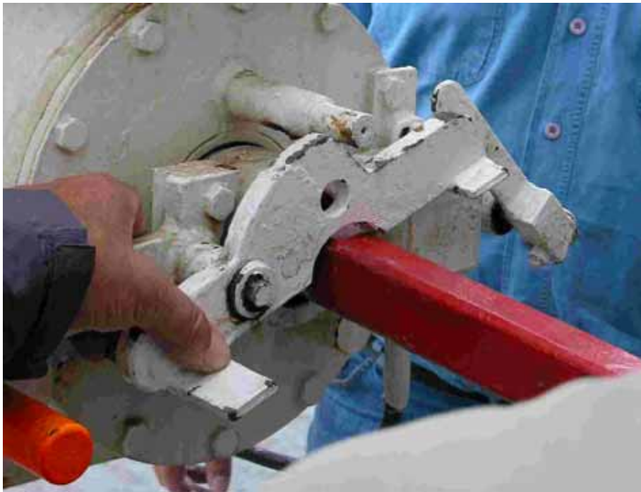
Abbildung 7: Sicherheitsriegel geöffnet (Kurbel aufgesteckt)
