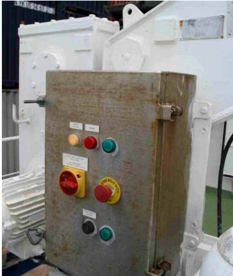
Abbildung 9: Toter Winkel hinter dem Bedienstandort
