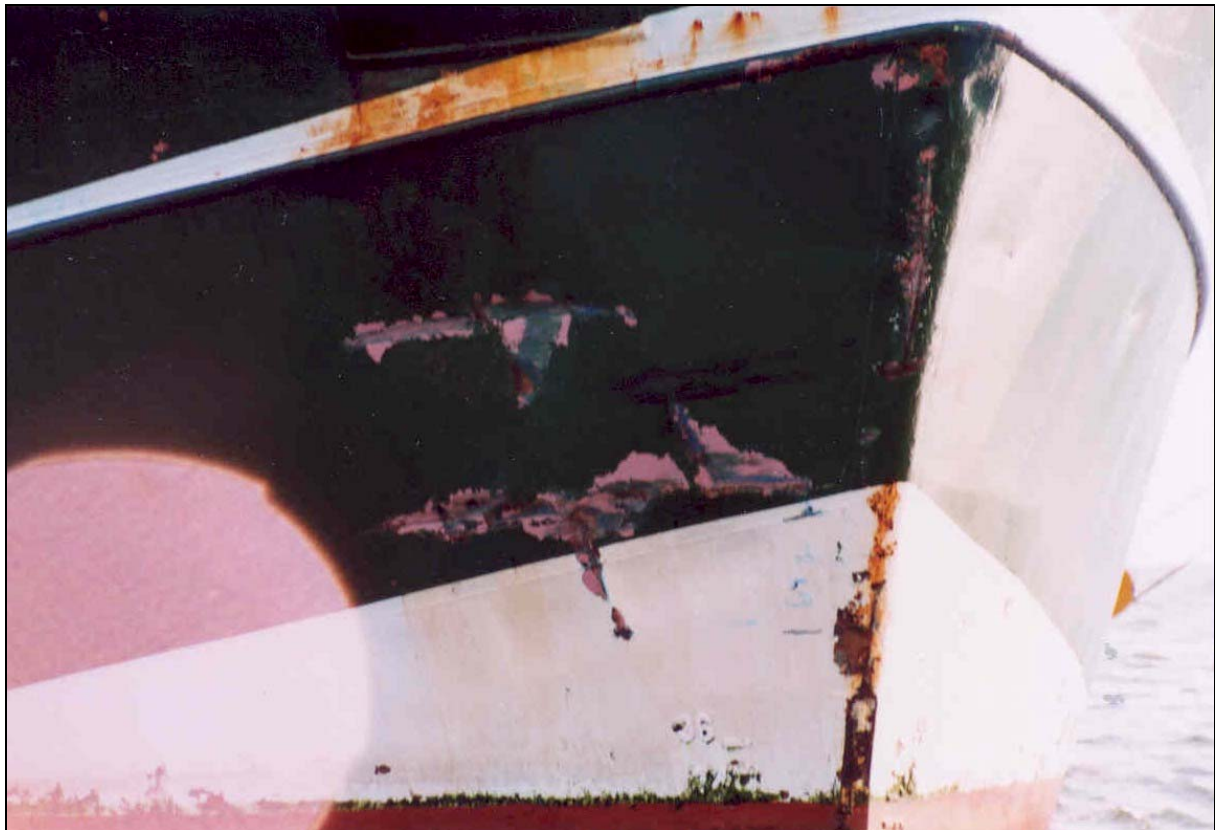
Abbildung 11: Schadensbild 1 - FK GRIETJE BOS UK-237
