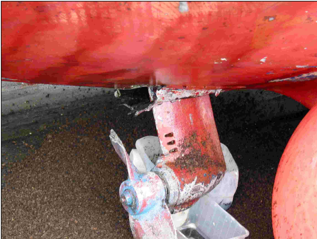
Abbildung 9: Nach vorne gedrückter Saildrive-Schaft und beschädigter Propeller
