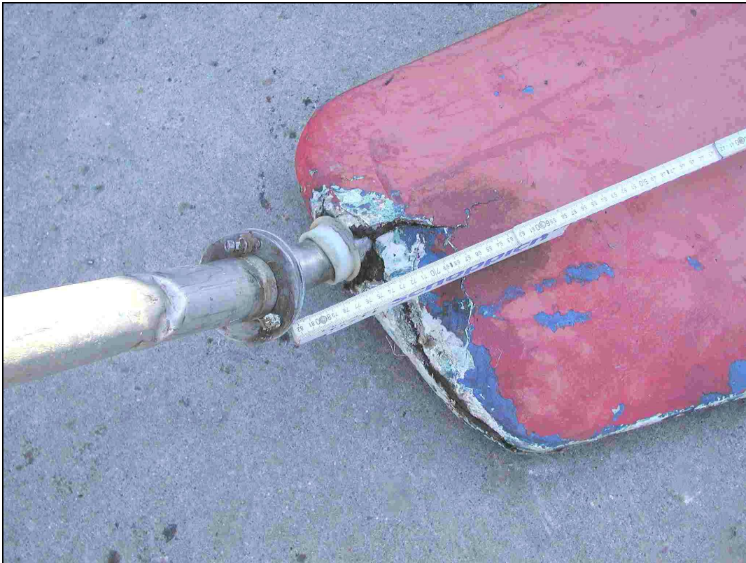
Abbildung 11: Oberer Teil des Ruderblattes mit Stauchung
