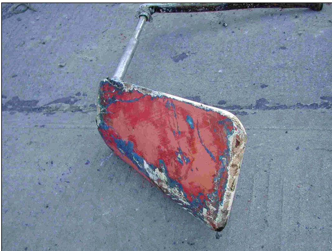
Abbildung 12: Ansicht der Ruderanlage
