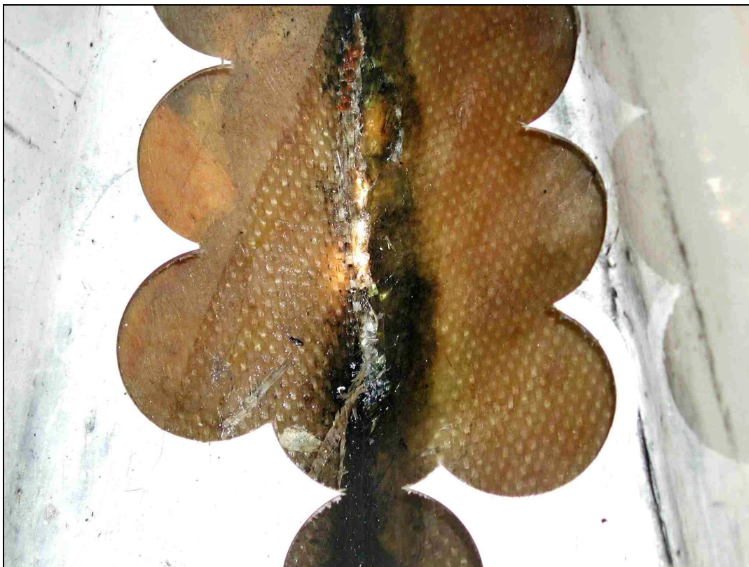
Abbildung 16: Schaden im Bugbereich
