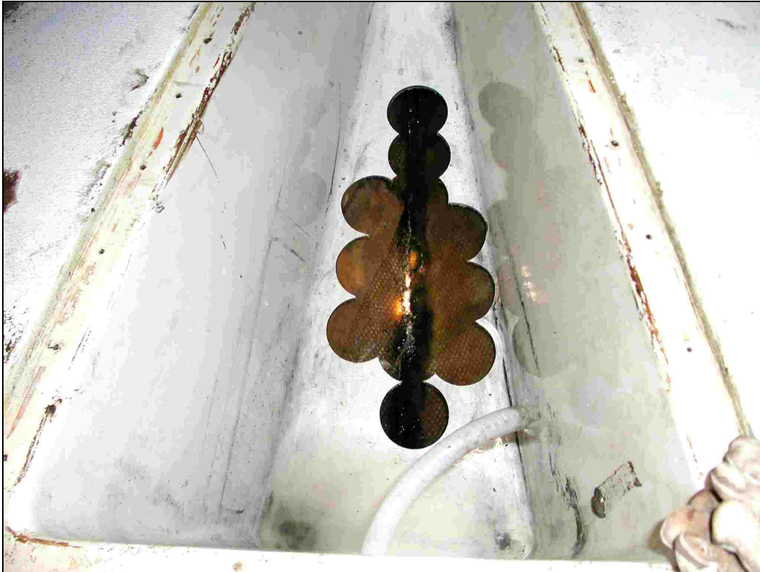
Abbildung 15: Aufgeschnittene Innenschale im Vorschiff
