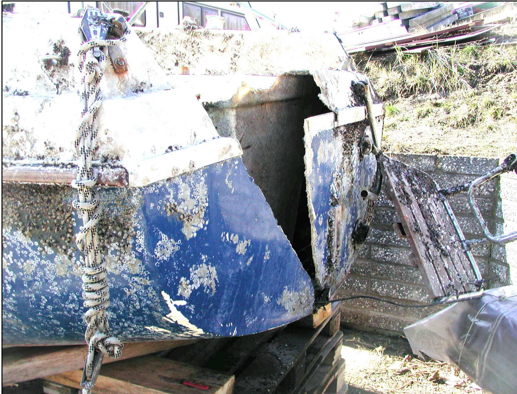
Abbildung 7: Gerade Schnittkanten am Heck
