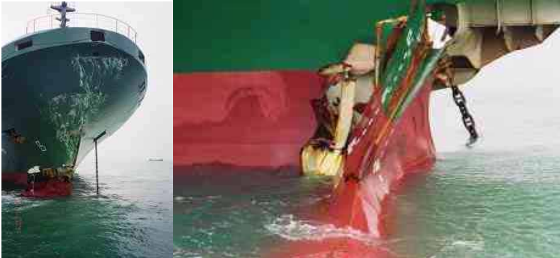
Abbildung 5: RITHI BHUM nach der Kollision (Fotos: Jacky Rickmers Schiffahrtsgesellschaft mbH & Cie.KG)
