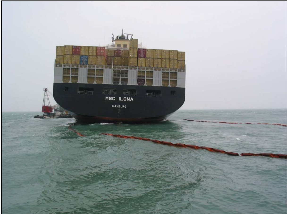
Abbildung 11: Ölsperre um MSC ILONA (Foto: BSU)
