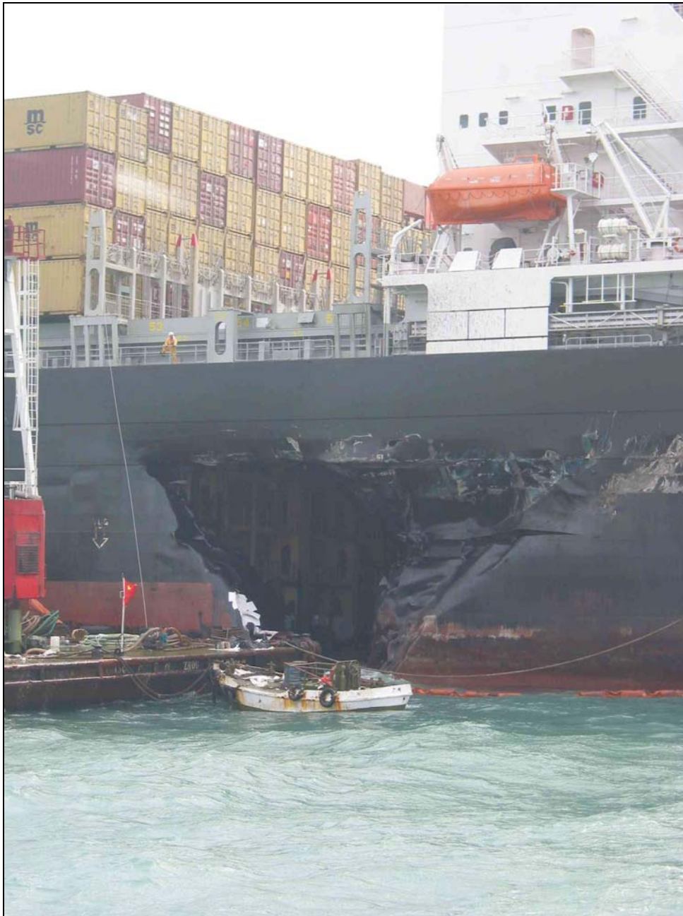
Abbildung 10: Beschädigung MSC ILONA (Foto: BSU)
