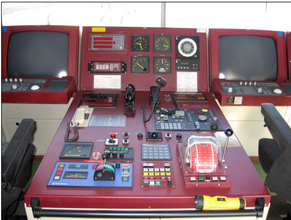
Abbildung 7: zentraler Fahrstand in der Brücke
