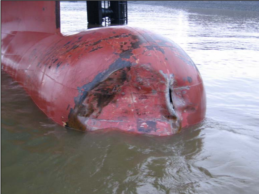
Abbildung 5: beschädigter Wulstbug der NYK ESPIRITO
