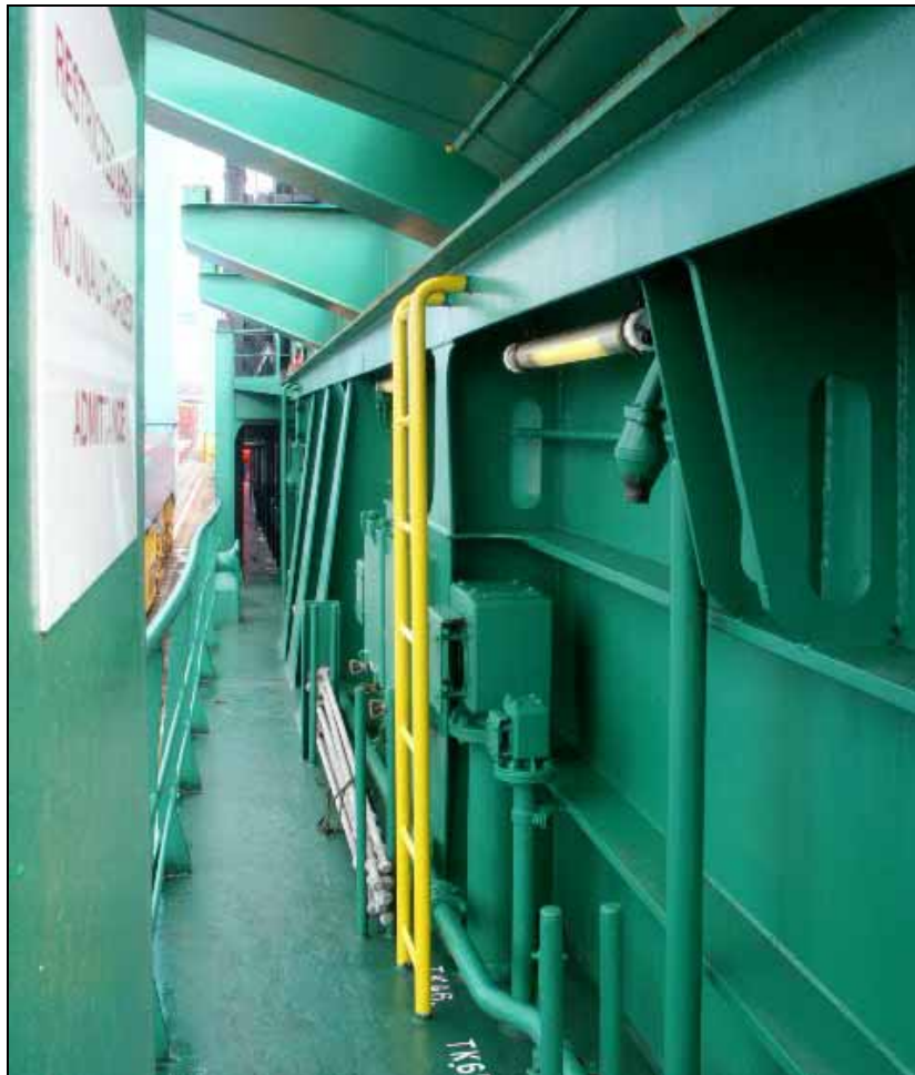
Abbildung 6: Aufstiegsmöglichkeit auf Luke 2 (zum Unfallzeitpunkt ohne Leiter)
