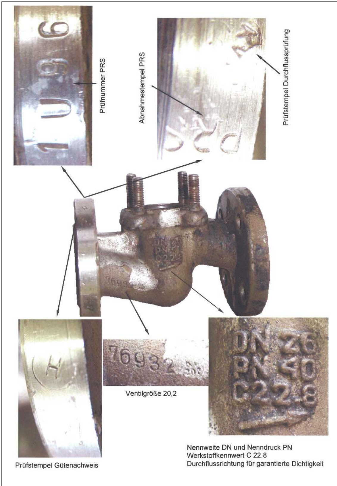
Abbildung 10: Kennzeichnungen am Ventil
