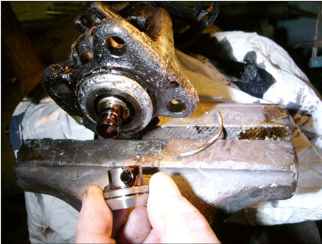
Abbildung 6: Draht ausgebaut und Kegel abgezogen
