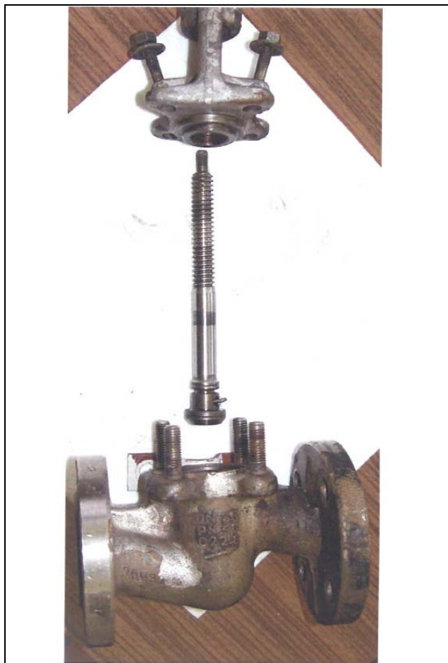
Abbildung 9: Ventil im demontierten und gereinigten Zustand
