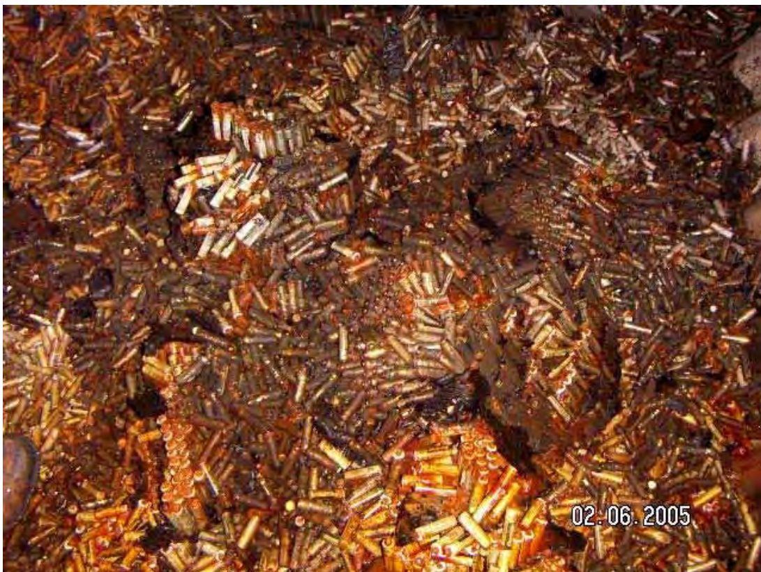
Abbildung 15: NiMH-Akkus nach dem Brand
