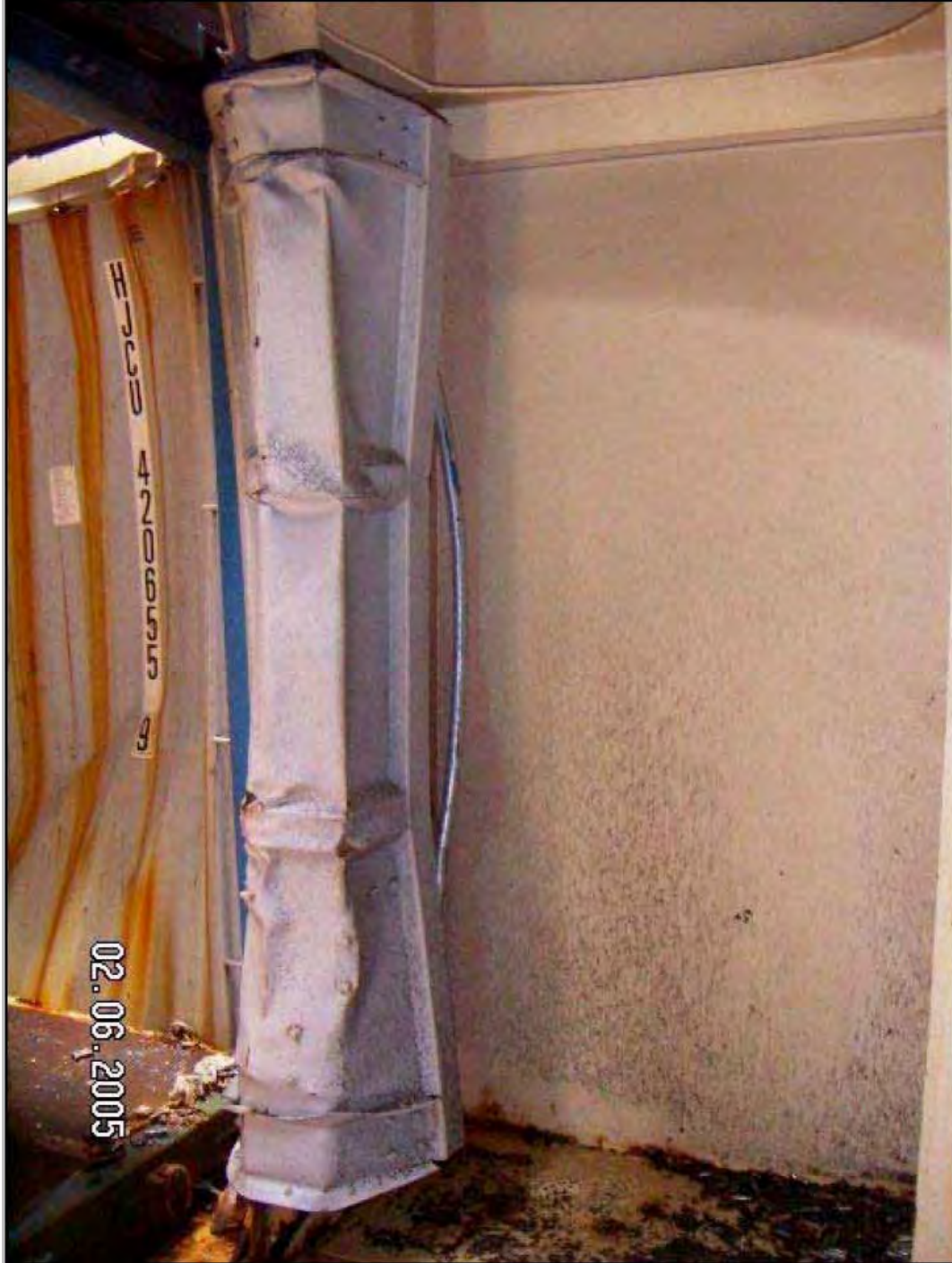
Abbildung 9: Containertür Container 1 um Spant gewickelt
