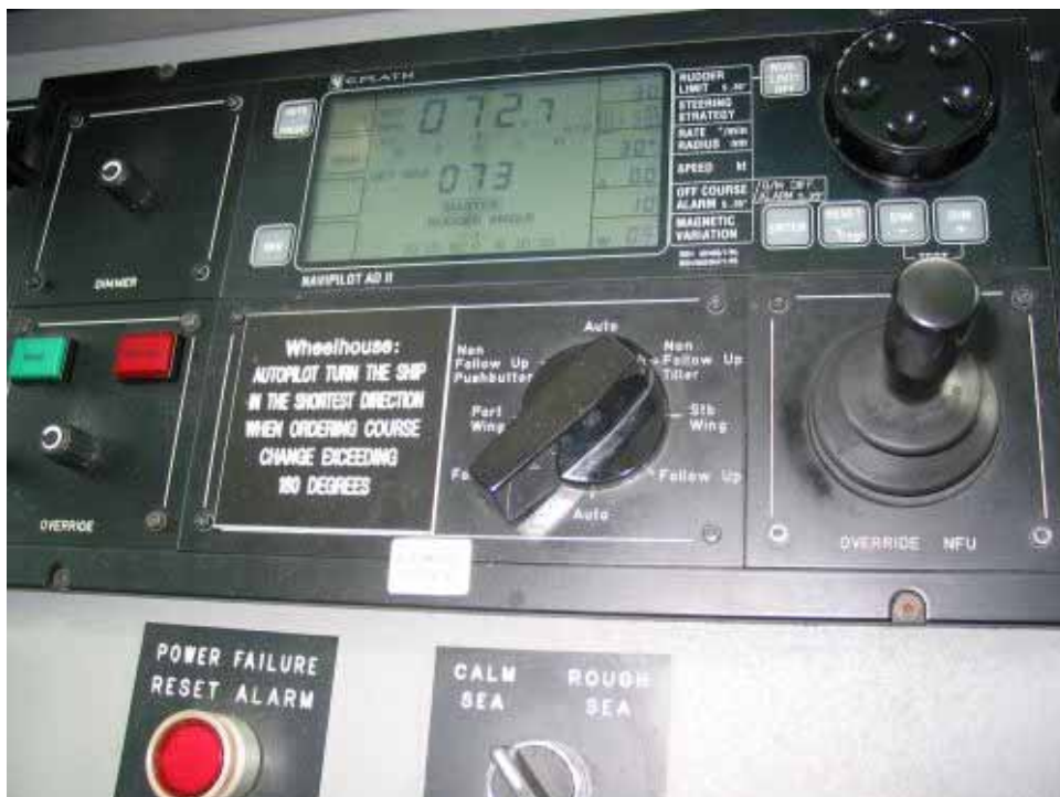
Abbildung 4: Ruderartenwahlschalter mit Selbststeueranlage
