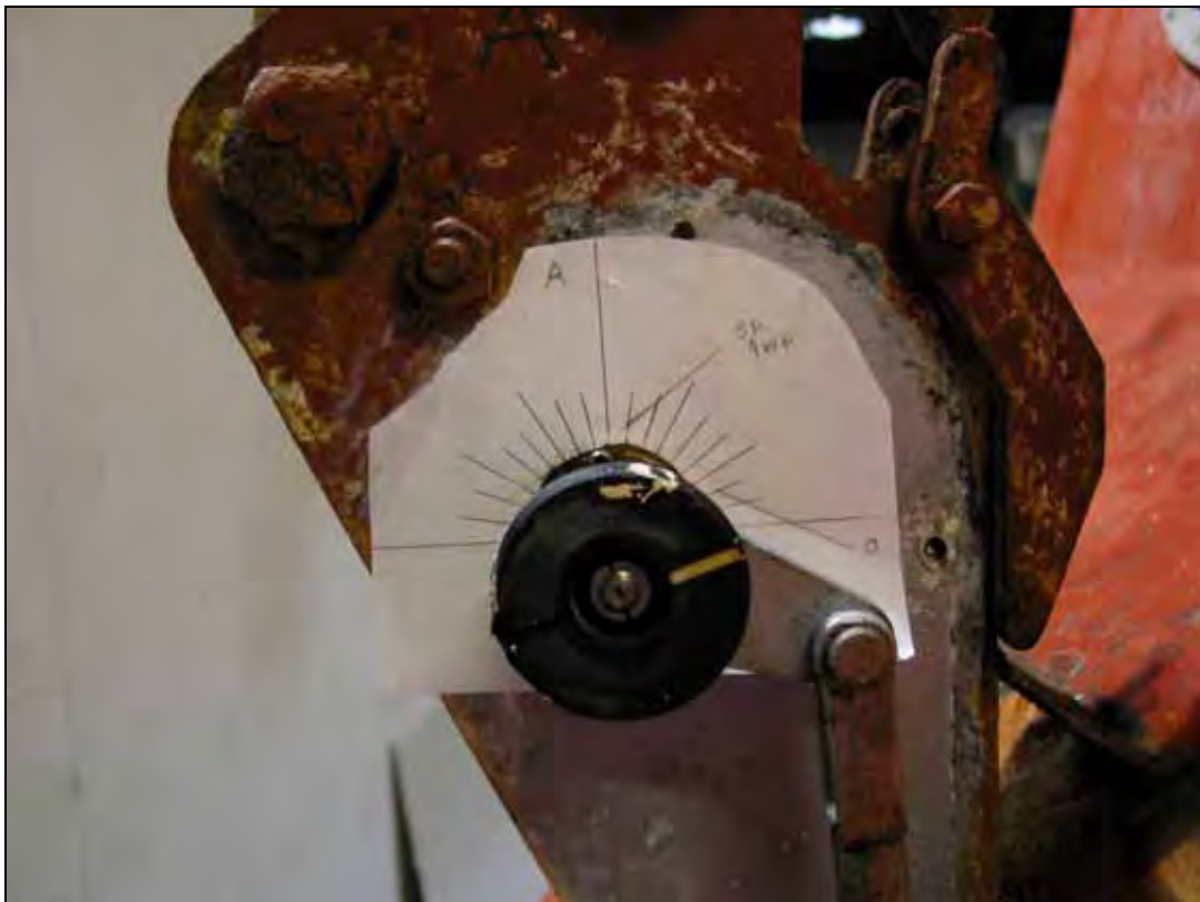
Abbildung 17: Hinterer Heißhaken mit Winkelscheibe und aufgetragenen Winkeln
