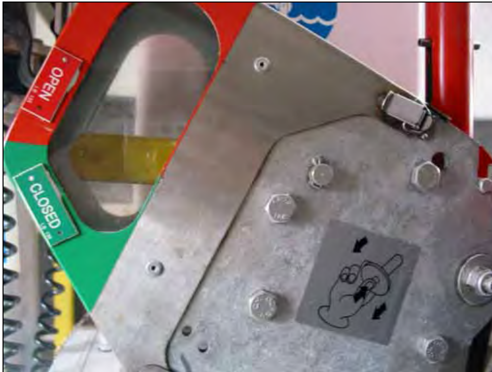
Abbildung 21: Auslöseeinheit des Steuerbordbootes der OLIVER JACOB; hier Abdeckung des Handgriffs der Hydrostatiksicherungsklappe mit Markierungen und gelber Handhebel der Hydrostatiksicherungsklappe
