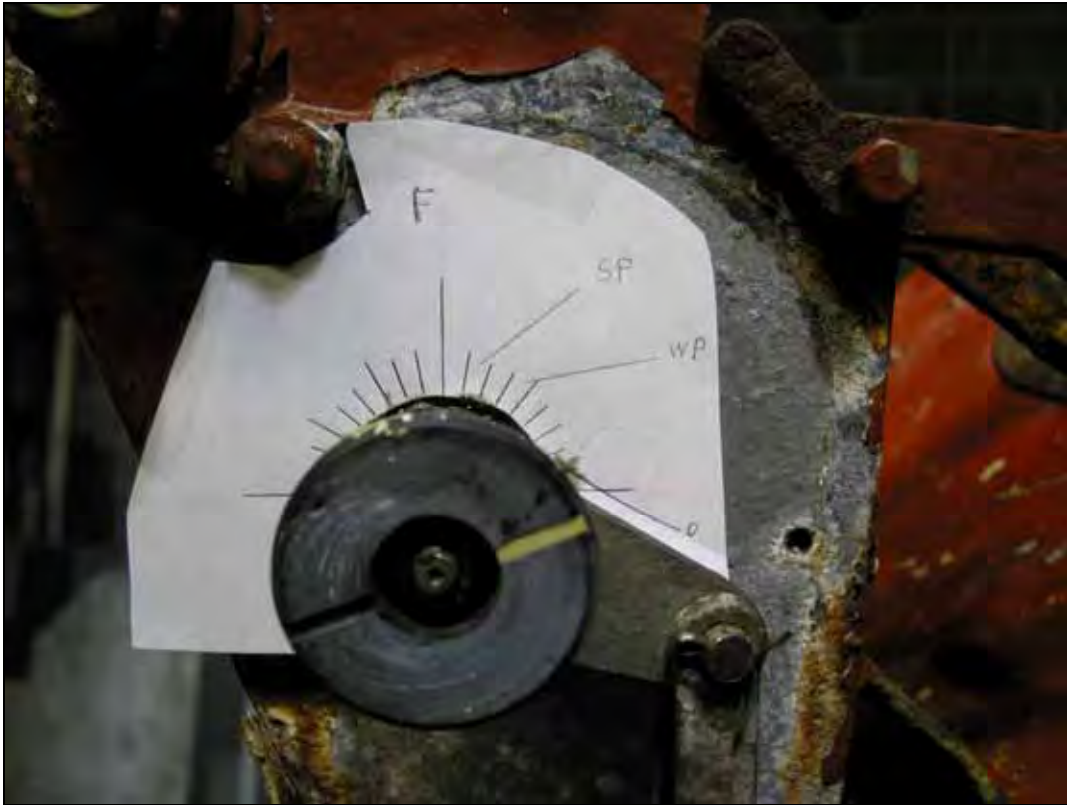
Abbildung 16: Vorderer Heißhaken mit Winkelscheibe und aufgetragenen Winkeln
