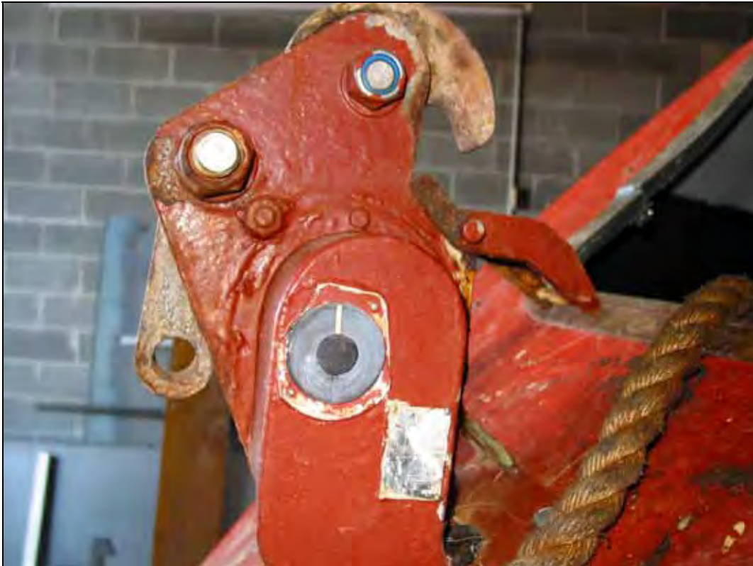
Abbildung 14: Vorderer Heihaken, Backbordseite, mit fehlendem roten und weien Sektor auf der Abdeckung
