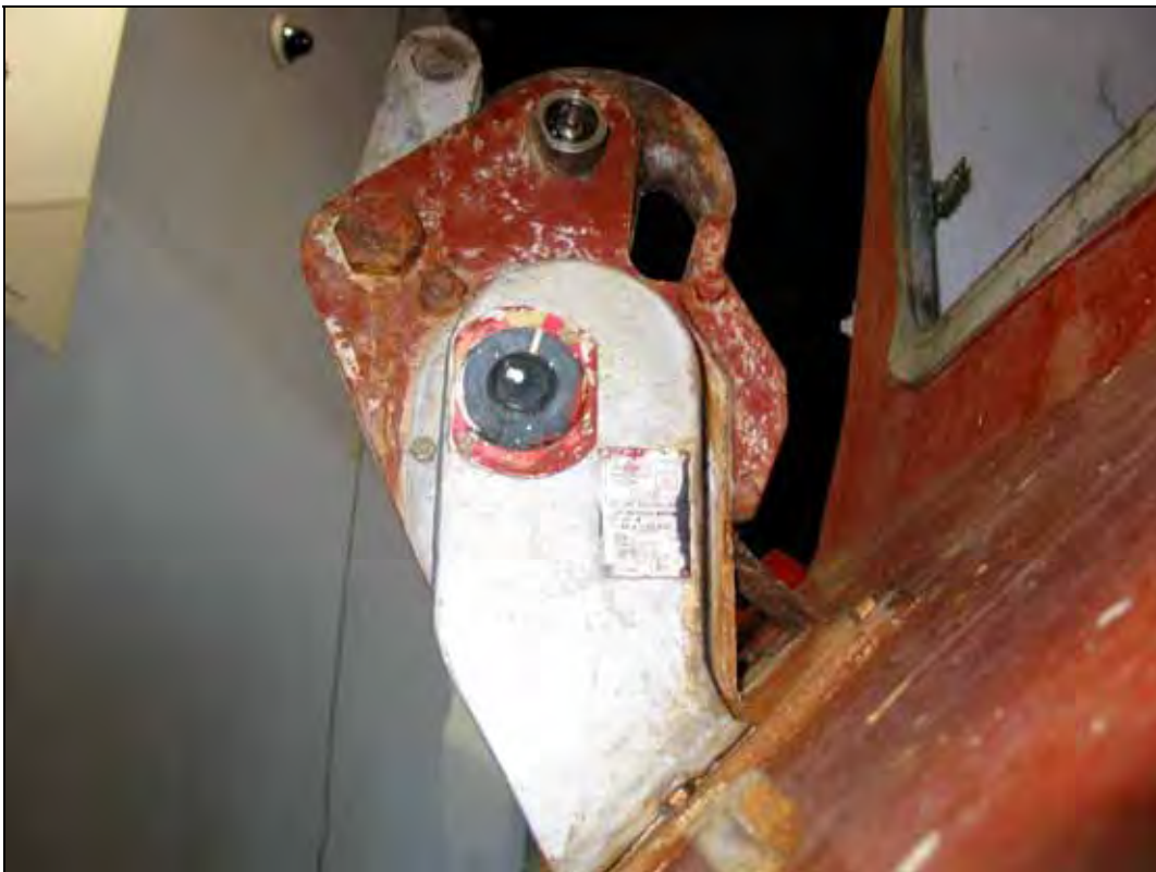
Abbildung 15: Hinterer Heihaken, Steuerbordseite, mit erneuerter Abdeckung
