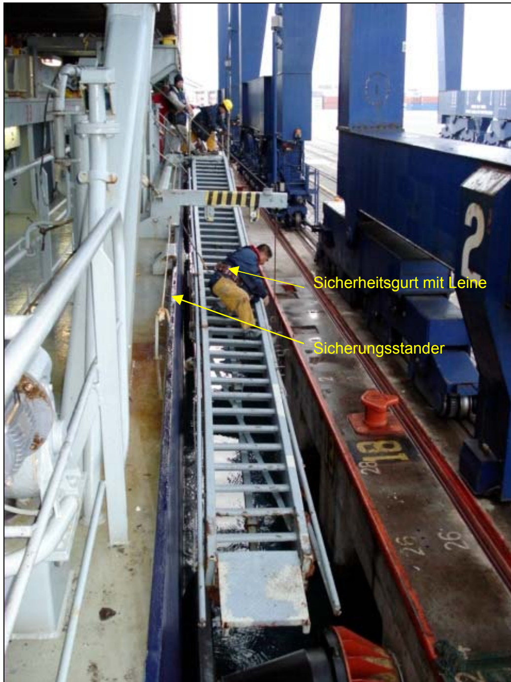
Abbildung 4: Ausgeklappte Gangway mit Sicherungsstander 4
