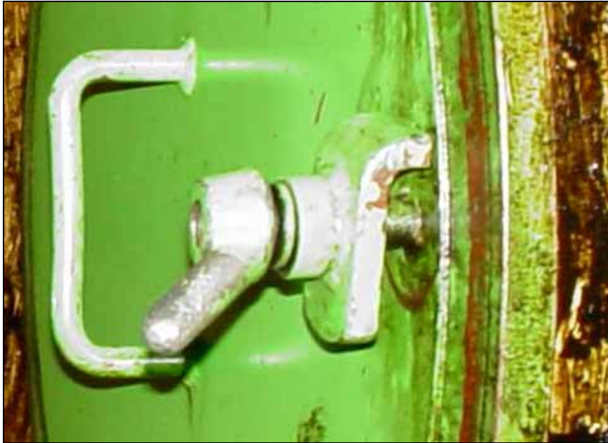
Abbildung 26: Riegel in geöffneter Position (L-Profil erkennbar)
