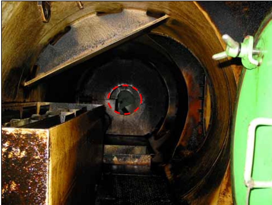
Abbildung 46: Person zwischen den Drosselblenden im achtern geschlossenen Kanal
