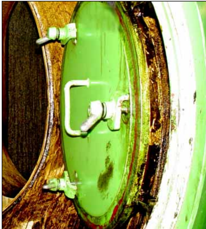
Abbildung 30: Verharren der Riegel in der tangentialen Öffnungsposition
