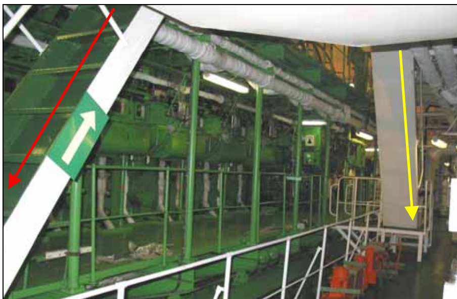
Abbildung 6: Niedergänge 1 und 2 von der Zylinderkopf- zur Spülluftkanalebene (2) 17
