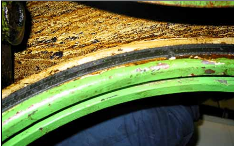
Abbildung 28: auf Lukenrahmen aufgeklebte Dichtungsschnur
