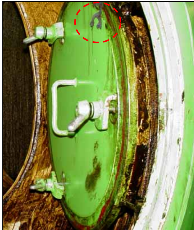
Abbildung 49: Überreste des eingeklemmten Gegenstandes – Gesamtaufnahme
