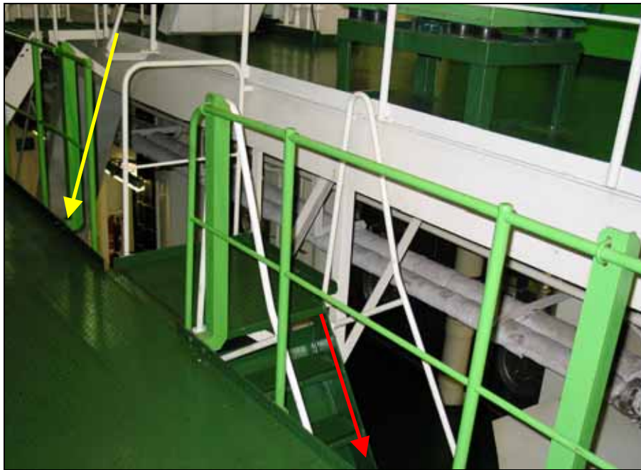
Abbildung 5: Niedergänge 1 und 2 von der Zylinderkopf- zur Spülluftkanalebene (1) 16
