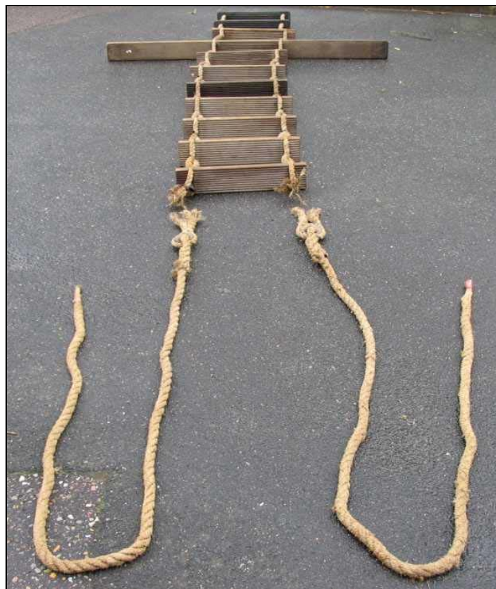
Abbildung 3: Gesamtaufnahme der Lotsenleiter vom oberen Ende
