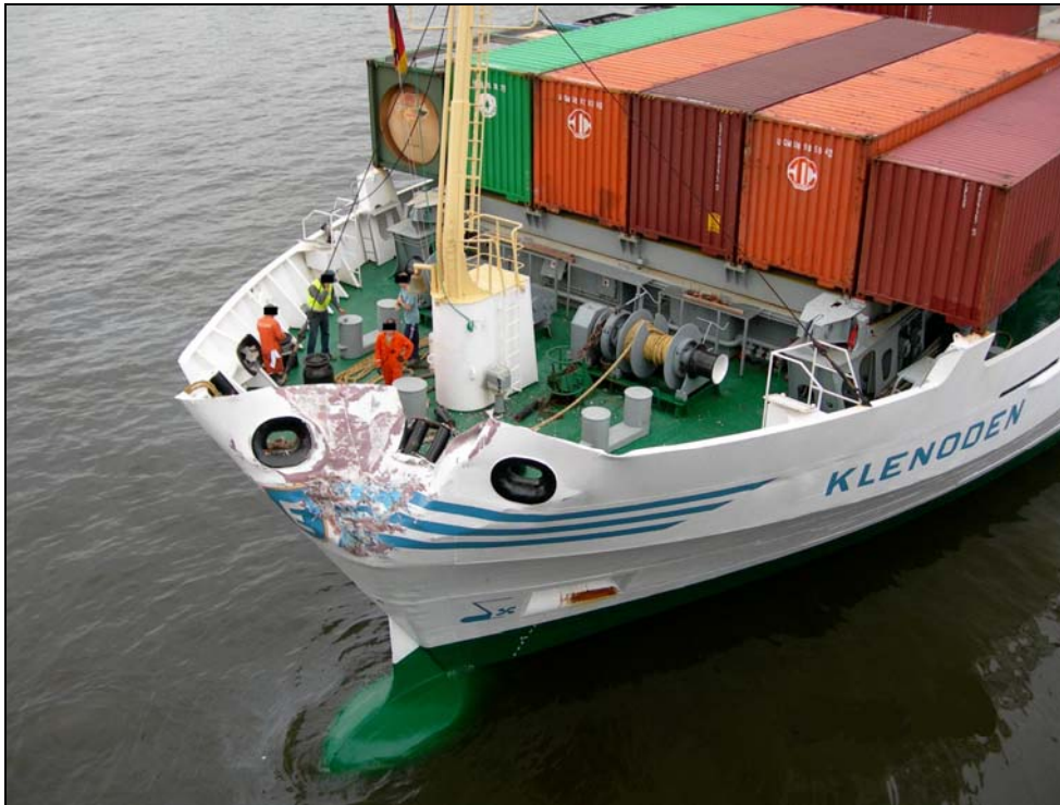
Abbildung 6: Schäden an Vorsteven und Vordermast der KLENODEN
