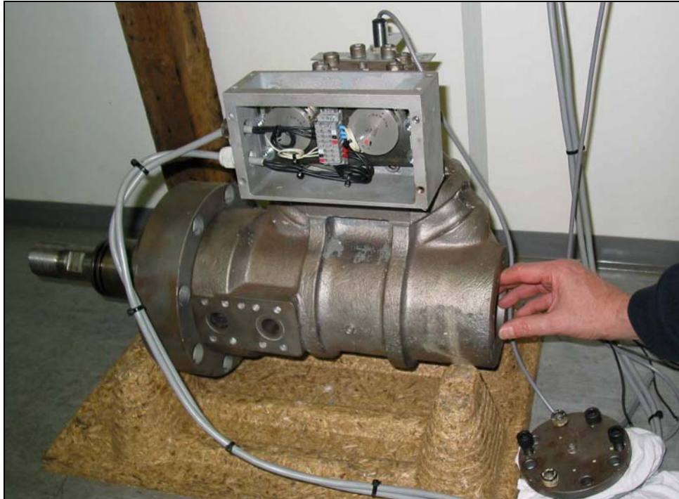
Abbildung 16: Baugleiche OD-Box (demontiert, auf dem Kopf stehend)
