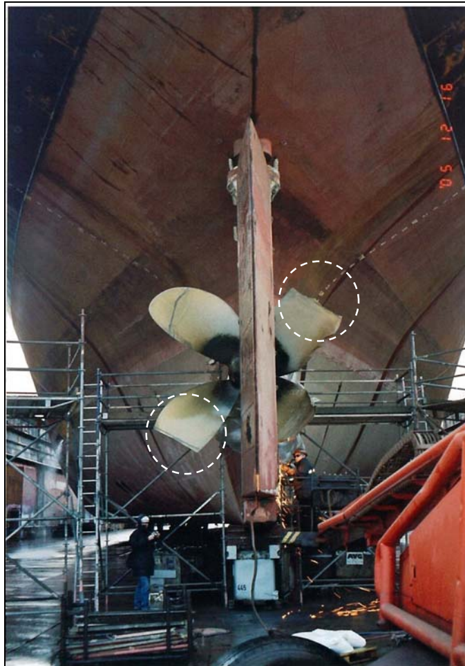
Abbildung 13: Beschädigung des Ruderblattes der Sunny Blossom
