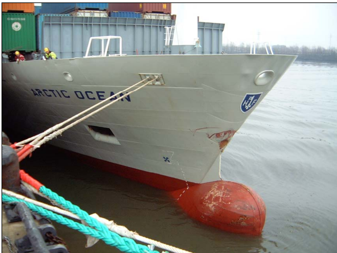
Abbildung 9: Beschädigung am Bug der Arctic Ocean
