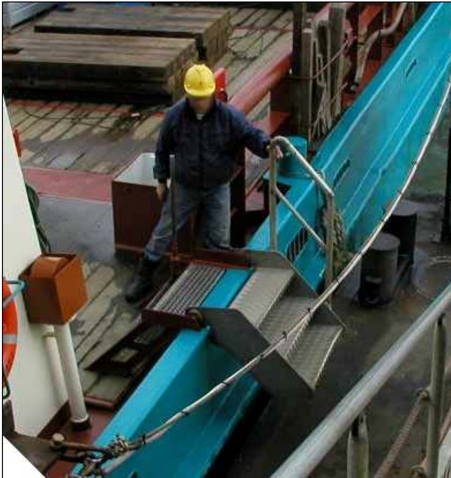
Abbildung 3: Treppe, wie zum Unfallzeitpunkt, ohne zweites Geländer und Handläufe
