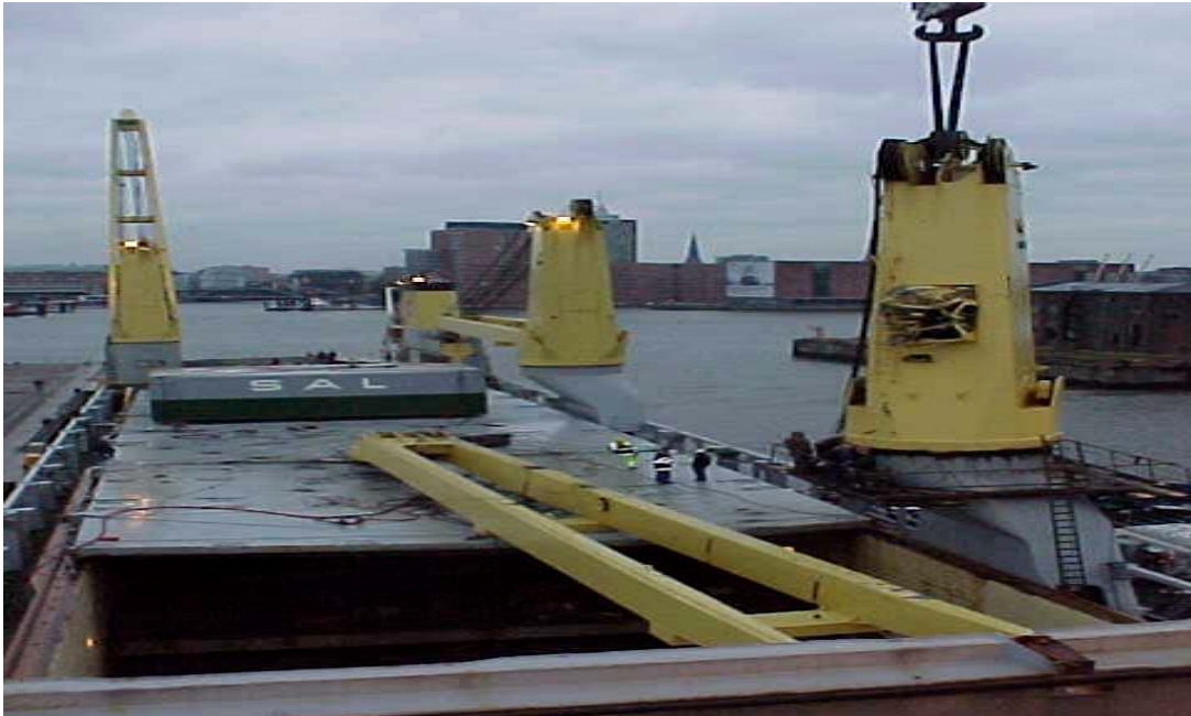
Abbildung 1: Blick von der Brücke achtern mit abgerissenem Ausleger
