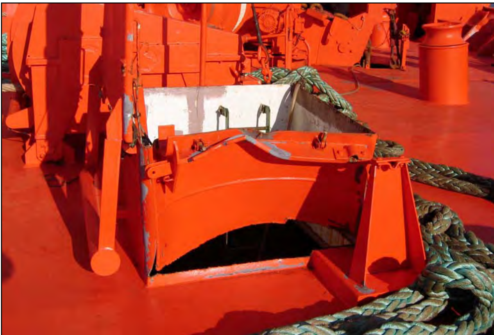
Abbildung 4: Beschädigter Lukeneinstieg auf der Back
