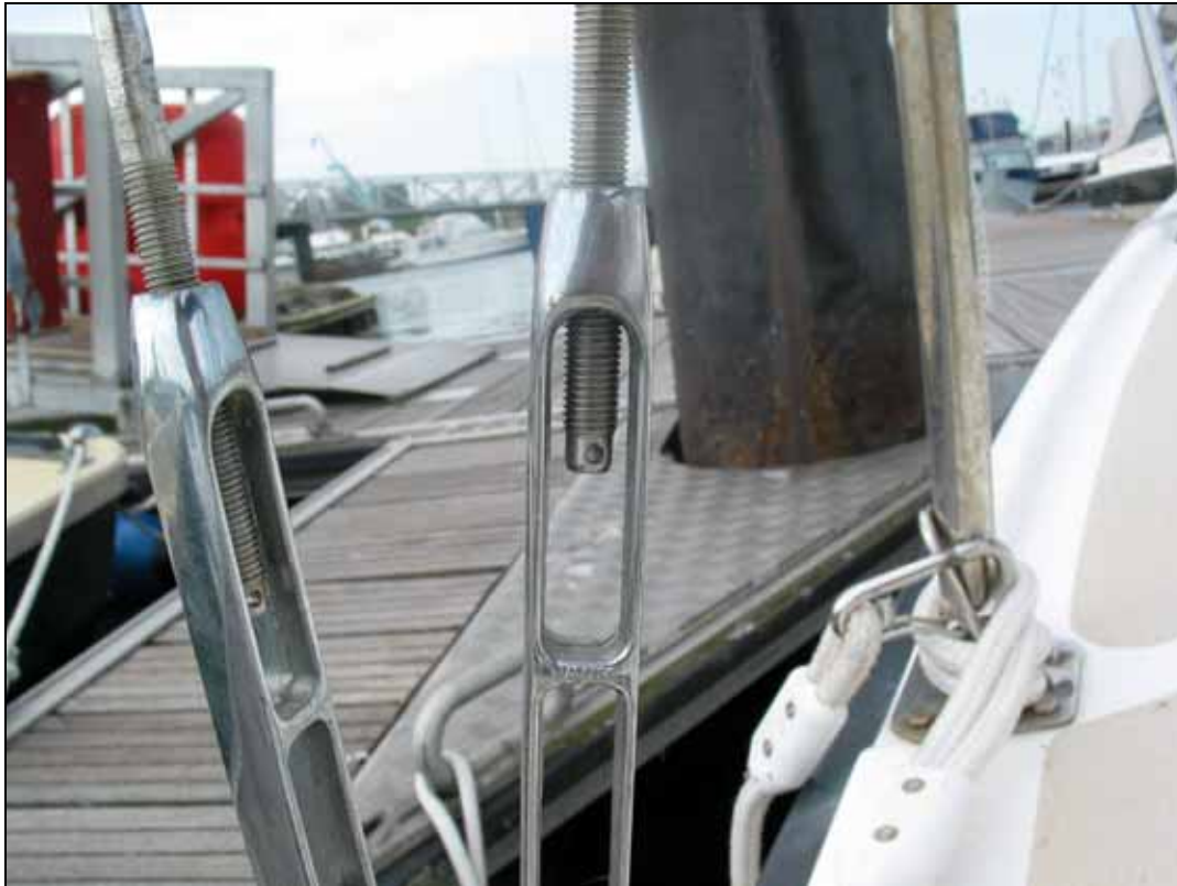
Abbildung 7: Offene Wantenspanner für Ober- und Unterwant ohne Sicherungssplint
