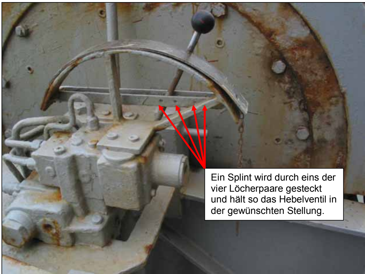
Abbildung 13: Hebelventil für Automatik-Betrieb der Winde
