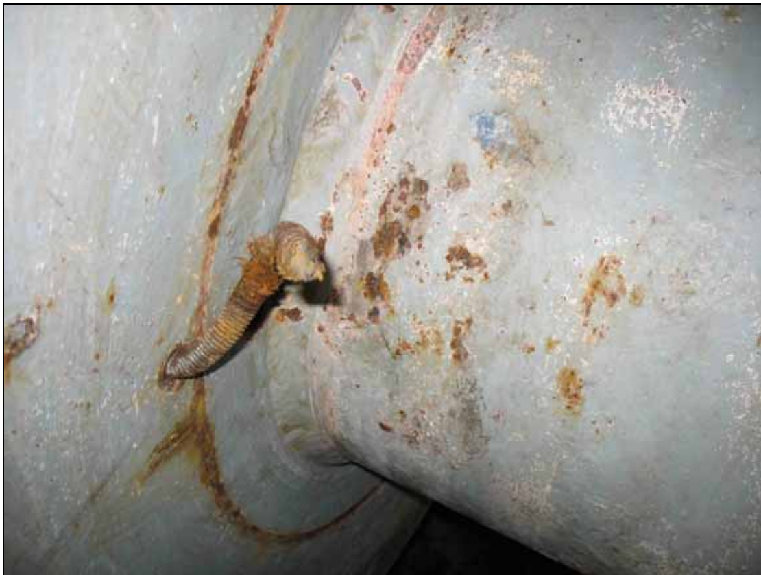
Abbildung 5: Herausgerissener Bolzen zum Halten des Leinenendes auf der Windentrommel
