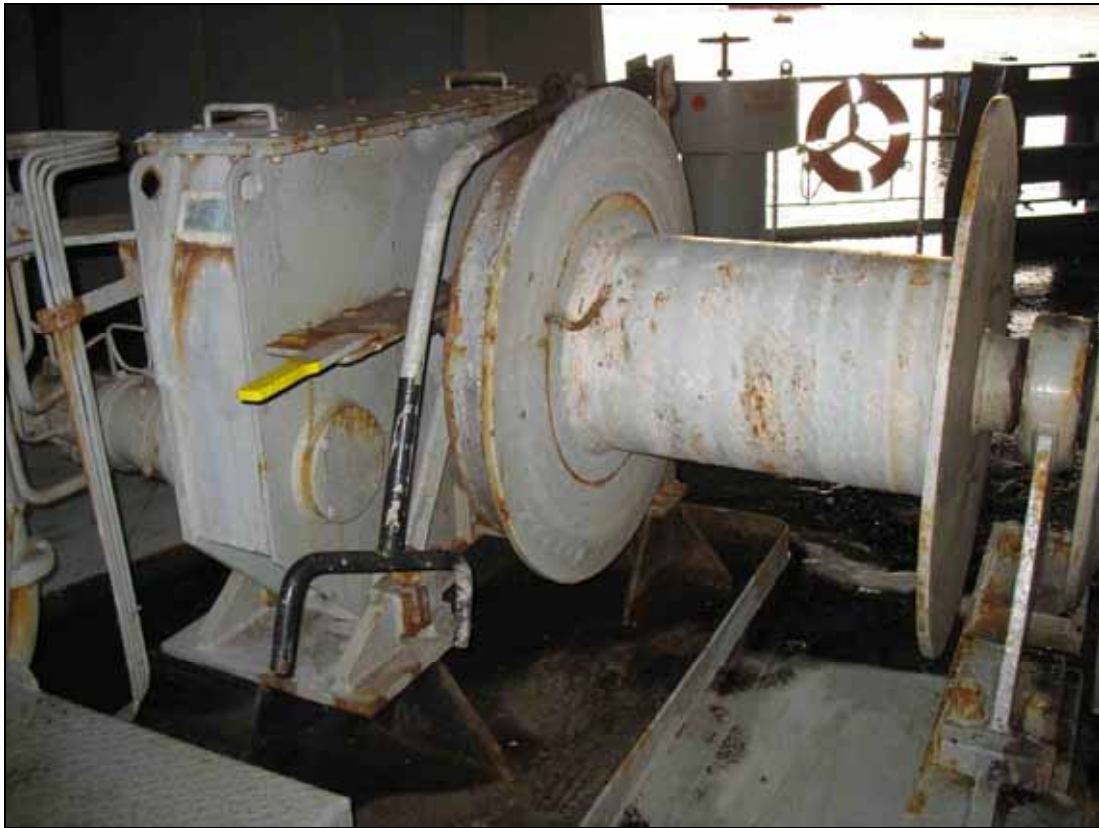
Abbildung 4: Verbogene Bremsspindel der Bb..-Winde
