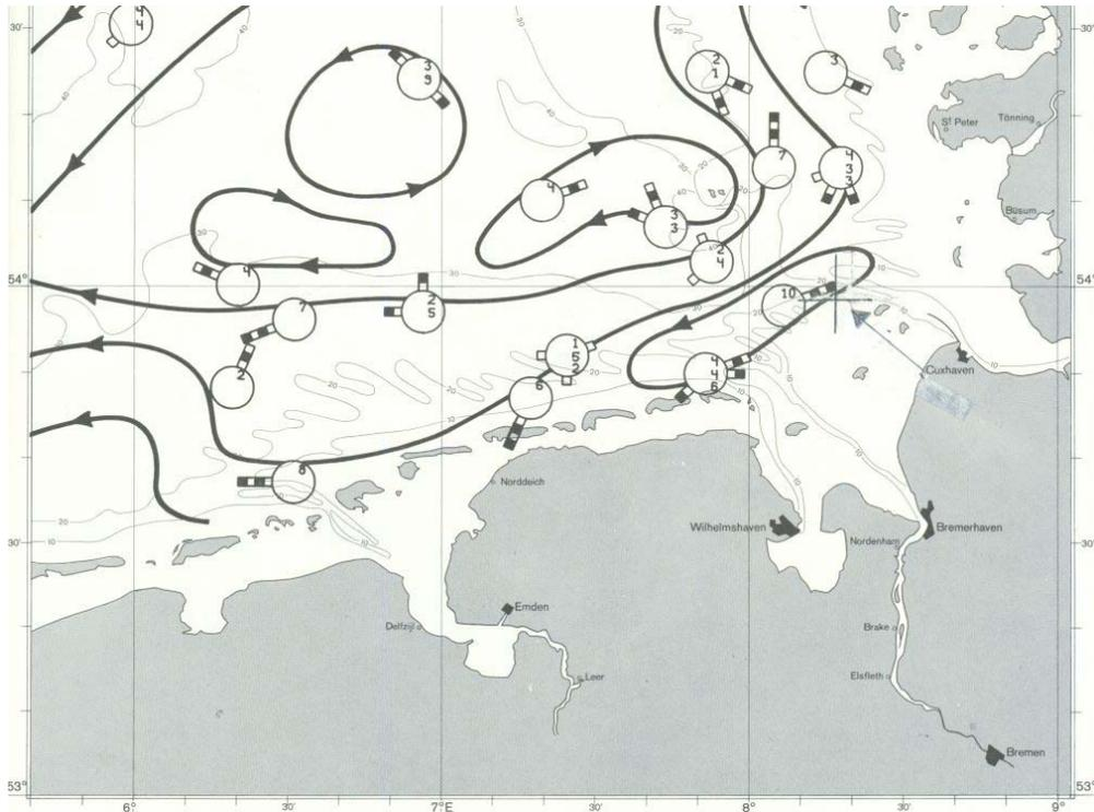
Abbildung 8: Auszug BSH-Nr. 2347, Reststrom Nordwind mit mittlerer Richtung
