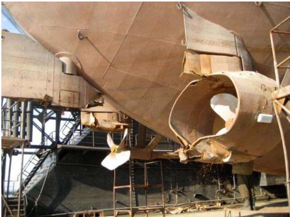
Abbildung 4: Schäden Achterschiff
