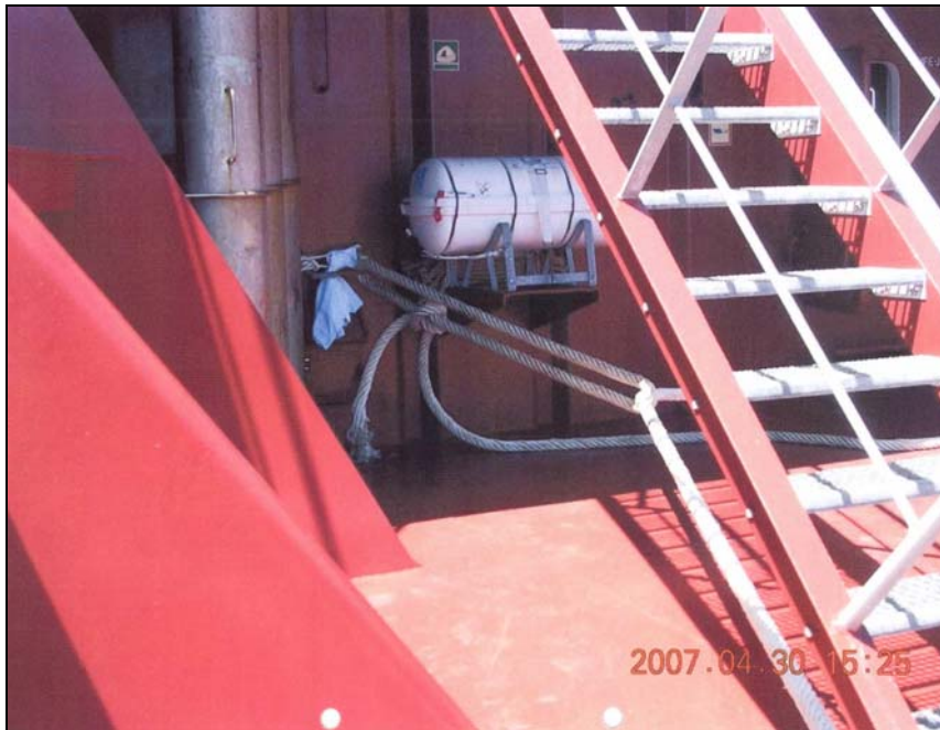
Abbildung 8: Befestigung des Stropps
