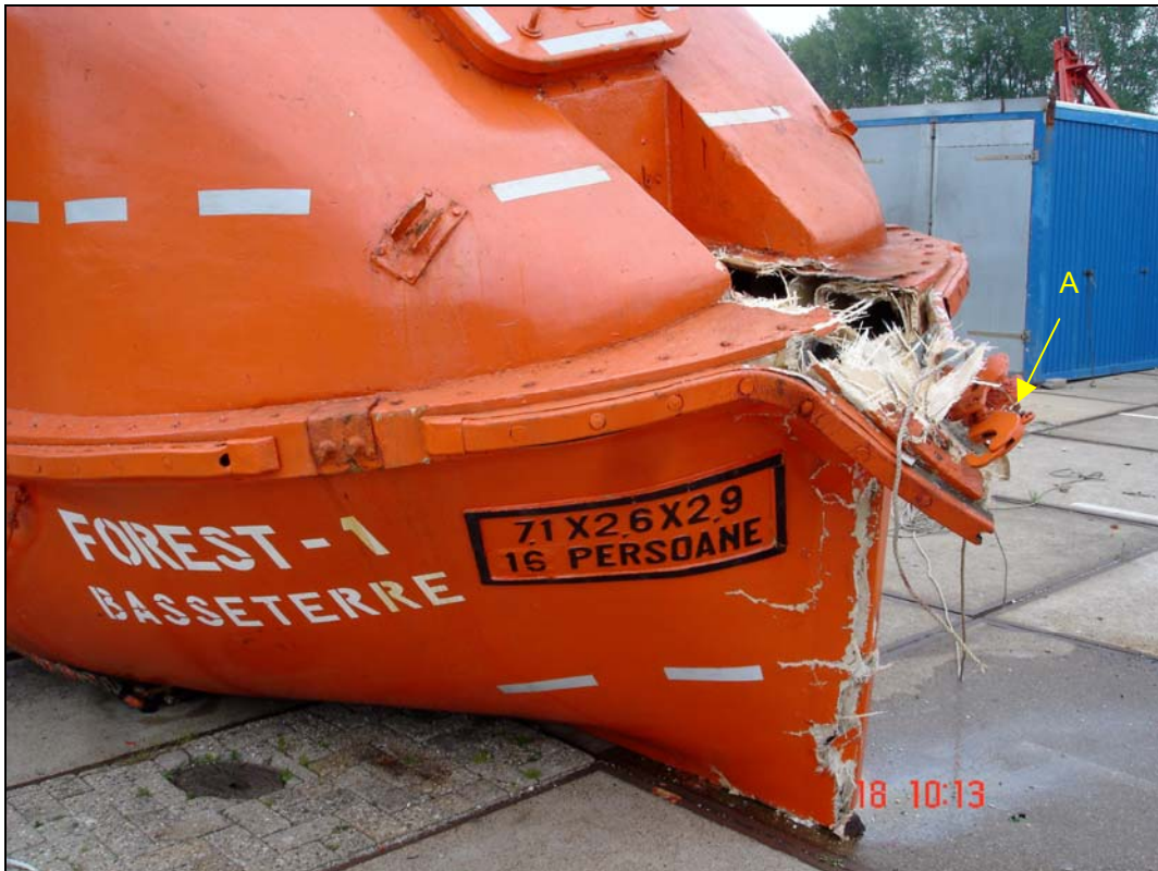
Abbildung 11: Beschädigung am Bug durch herausgerissenen Heißhaken; A – Haken der vorderen Fangleine
