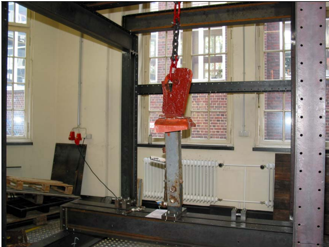
Abbildung 20: Versuchsaufbau mit hinterem Heißhaken (Seitenansicht)
