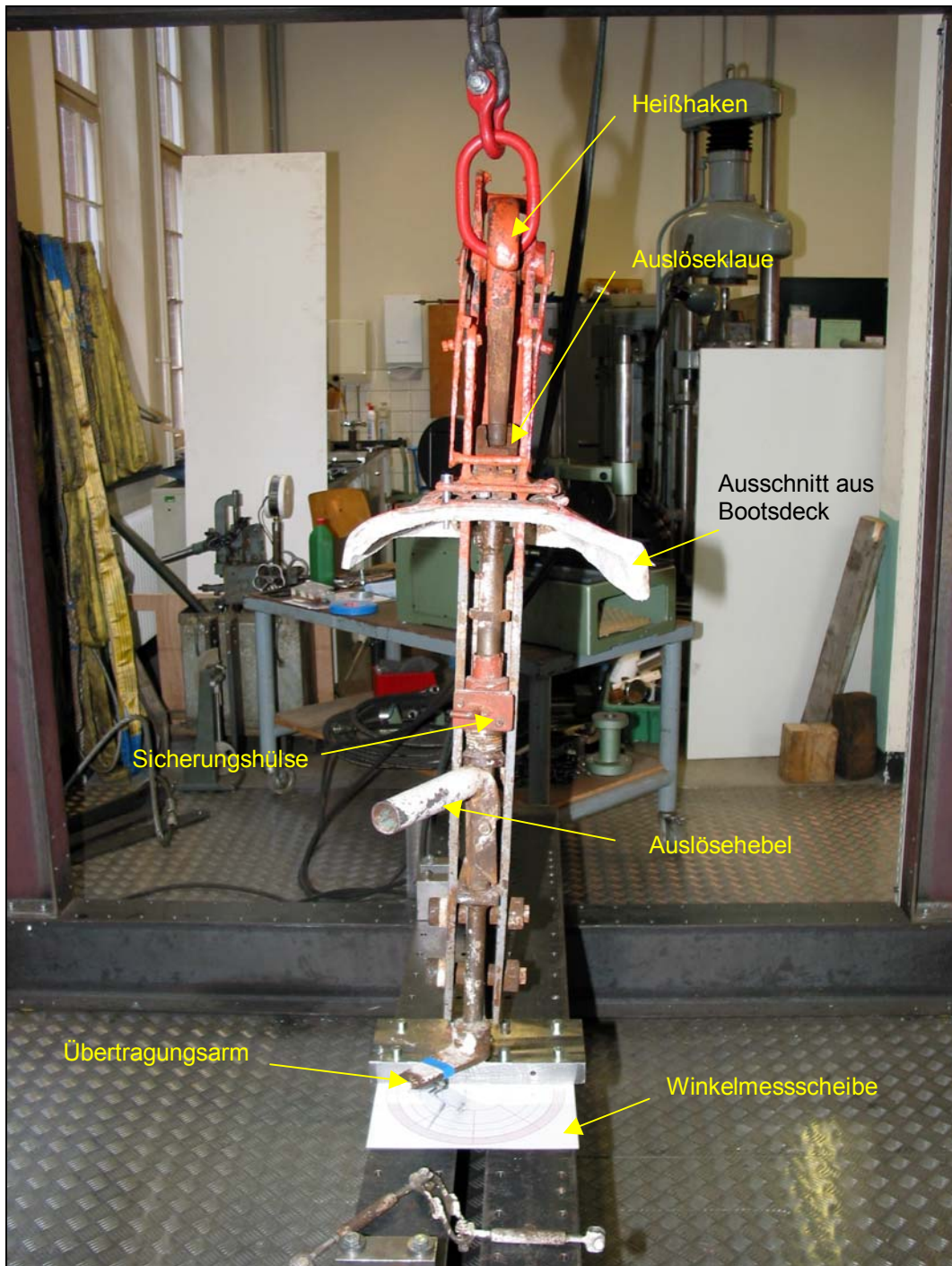
Abbildung 21: Versuchsaufbau mit hinterem Heißhaken (Frontansicht)
