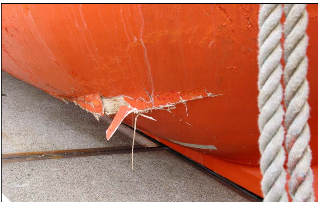
Abbildung 10: Aufgebrochener Rumpf backbord achtern
