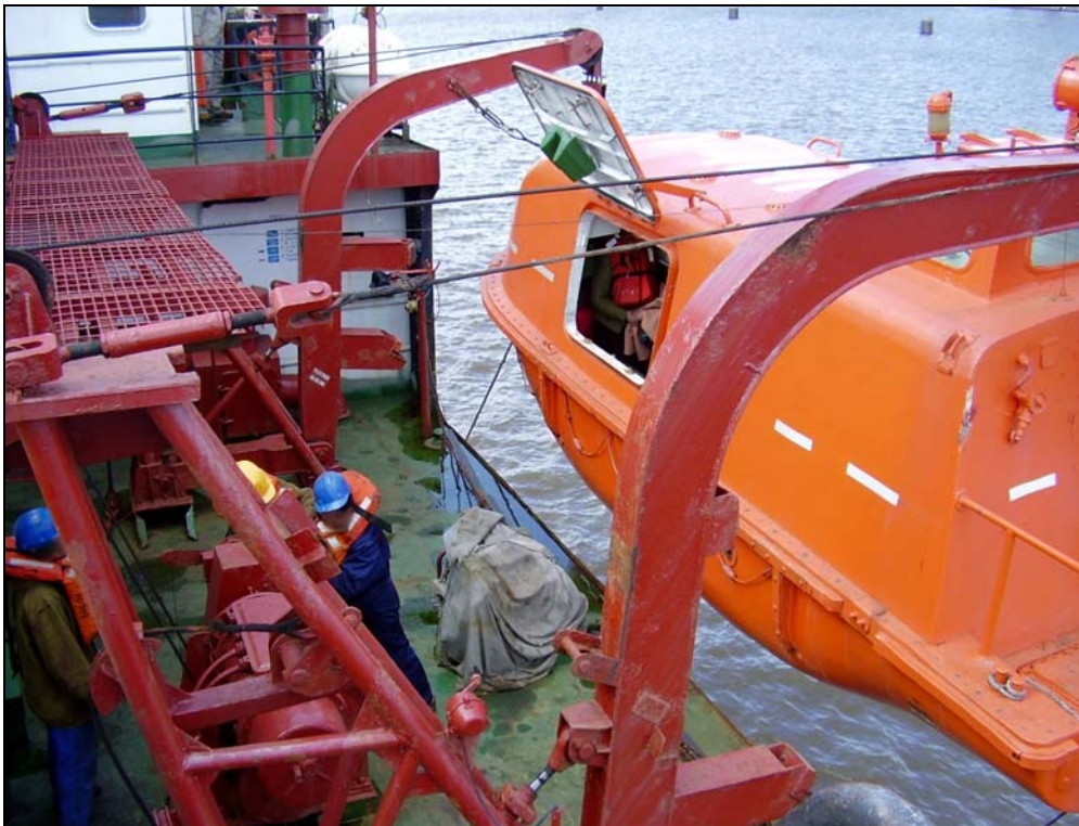
Abbildung 6: Kombiniertes Rettungs- und Bereitschaftsboot der FOREST-1
