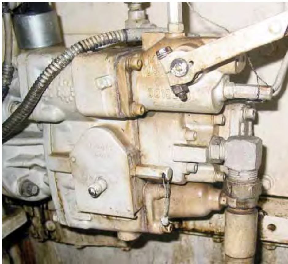
Abbildung 19: Verplombte Einspritzpumpe der Bb.-Hauptmaschine der LASS URANUS
