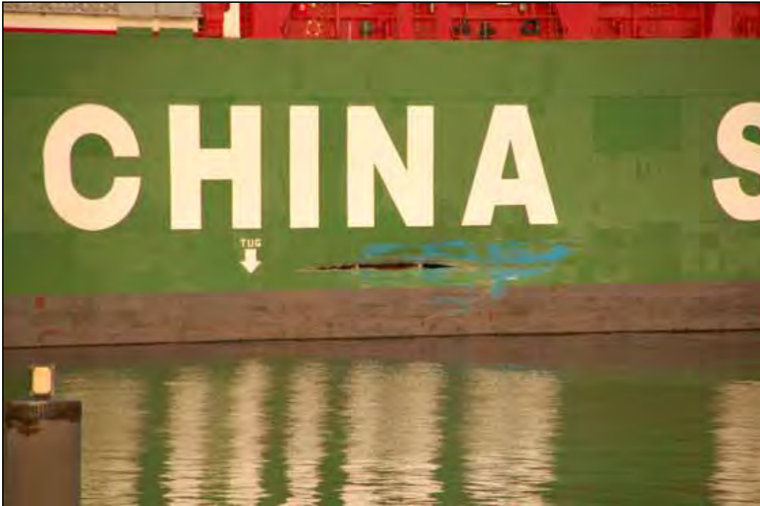
Abbildung 16: Detailaufnahme des Risses an der Steuerbordseite der XIN FU ZHOU
