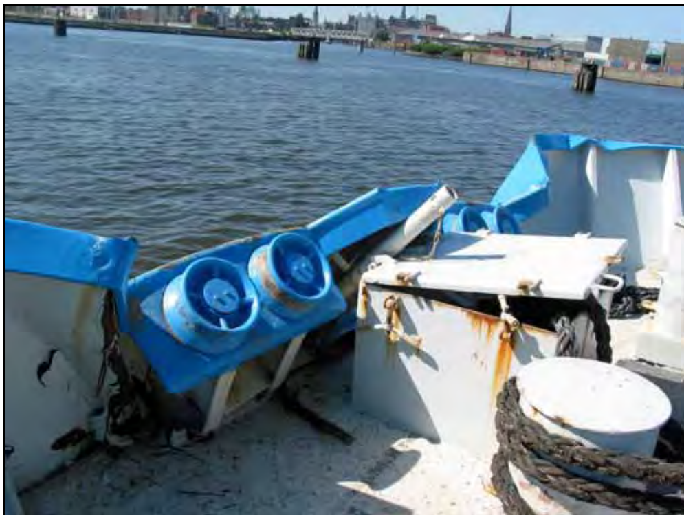
Abbildung 13: Schaden auf dem Vordeck der LASS URANUS
