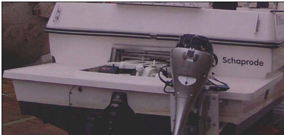
Abbildung 16: Verlängerter Heckspiegel der BAHAGO II mit Einbaumotor und Hilfsmotor
