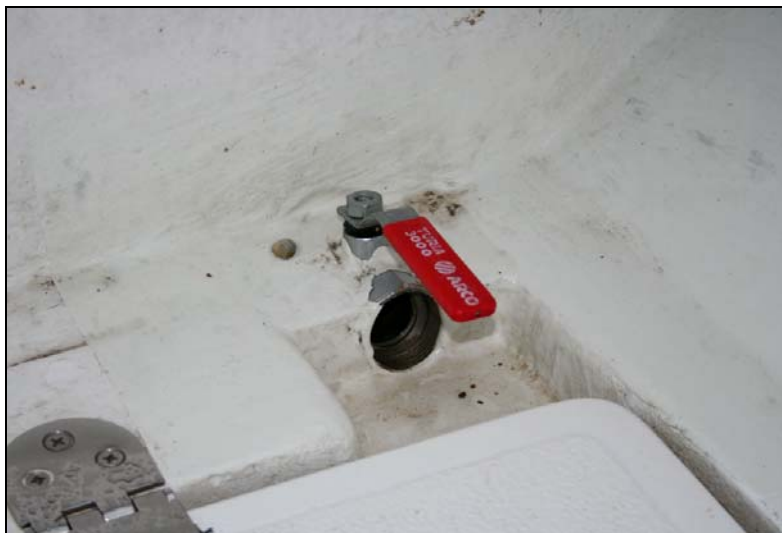
Abbildung 21: Nachgerüstetes Ventil für die Lenzöffnung
