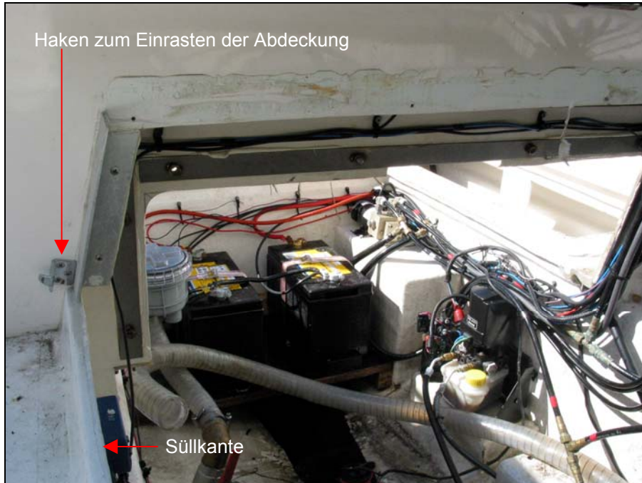
Abbildung 19: Motoröffnung am Heckspiegel bei ausgebautem Motor
