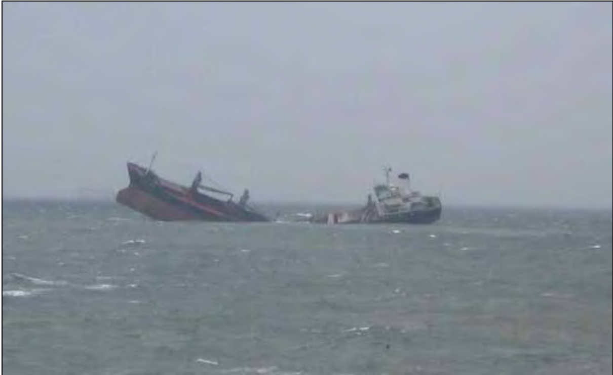
Abbildung 10: Durchbrechen der CHANG TONG kurz nach Durchzug des Taifuns
