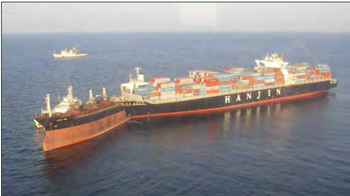
Abbildung 8: Verkeilte Fahrzeuge nach der Kollision
