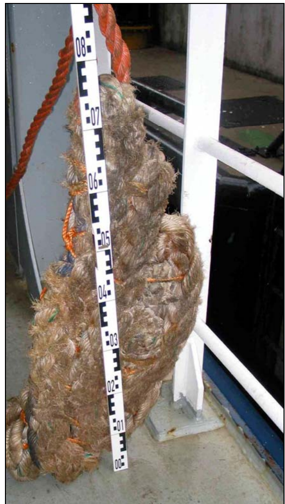
Abbildung 7: Fender – ähnlich dem mitgerissenen Fender
