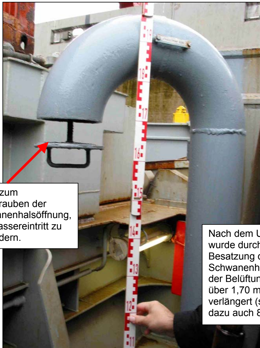
Abbildung 8: Schwanenhals der Belüftung - nach der Verlängerung
