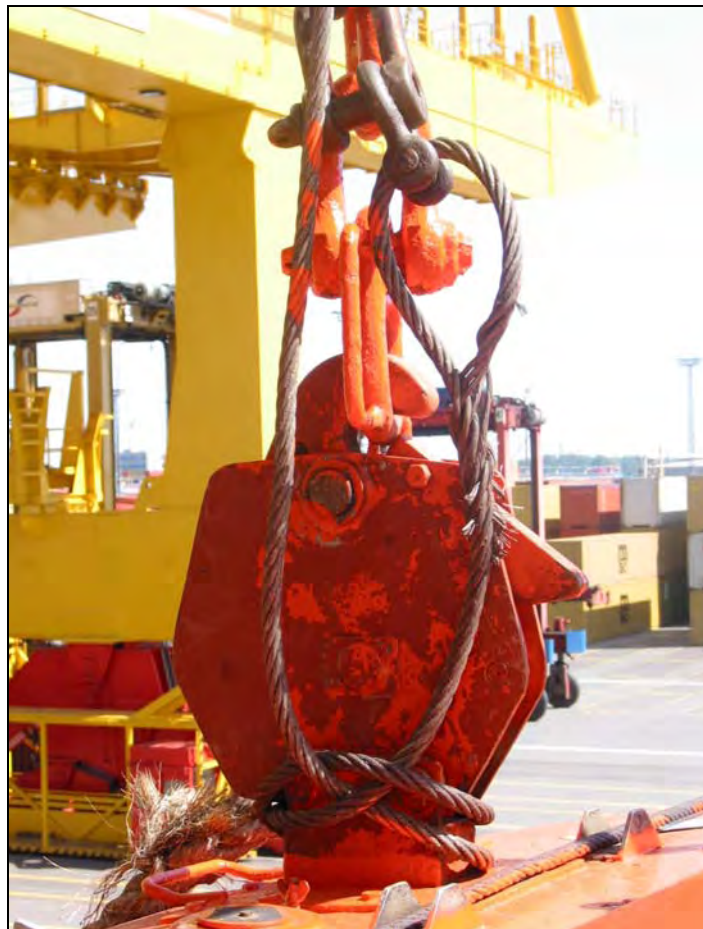
Abbildung 8: Vorderer Heißhaken des Steuerbord-Rettungsbootes mit Sicherungsdraht
