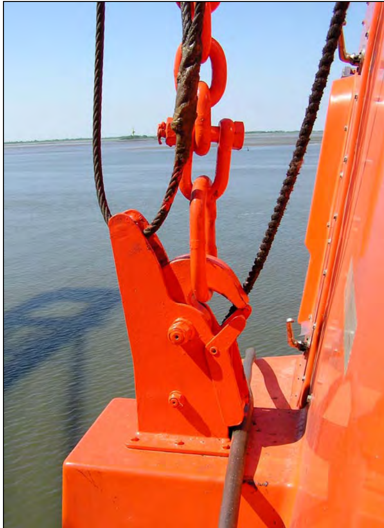
Abbildung 19: Achterer Heißhaken am neuen Backbord-Rettungsboot, Markierung nicht mehr erkennbar
